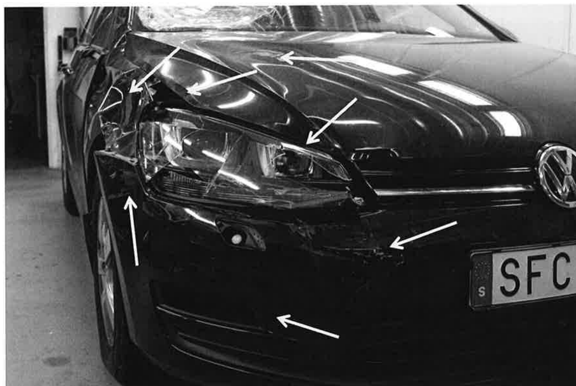
Bild 3. Fordonets högra front med de största skadorna markerade med gula pilar.
