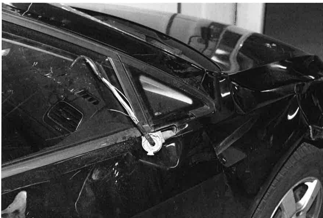
Bild 4. Visar skadorna vid infästningen till höger sidospegel samt intryckningen på höger framskärm.
