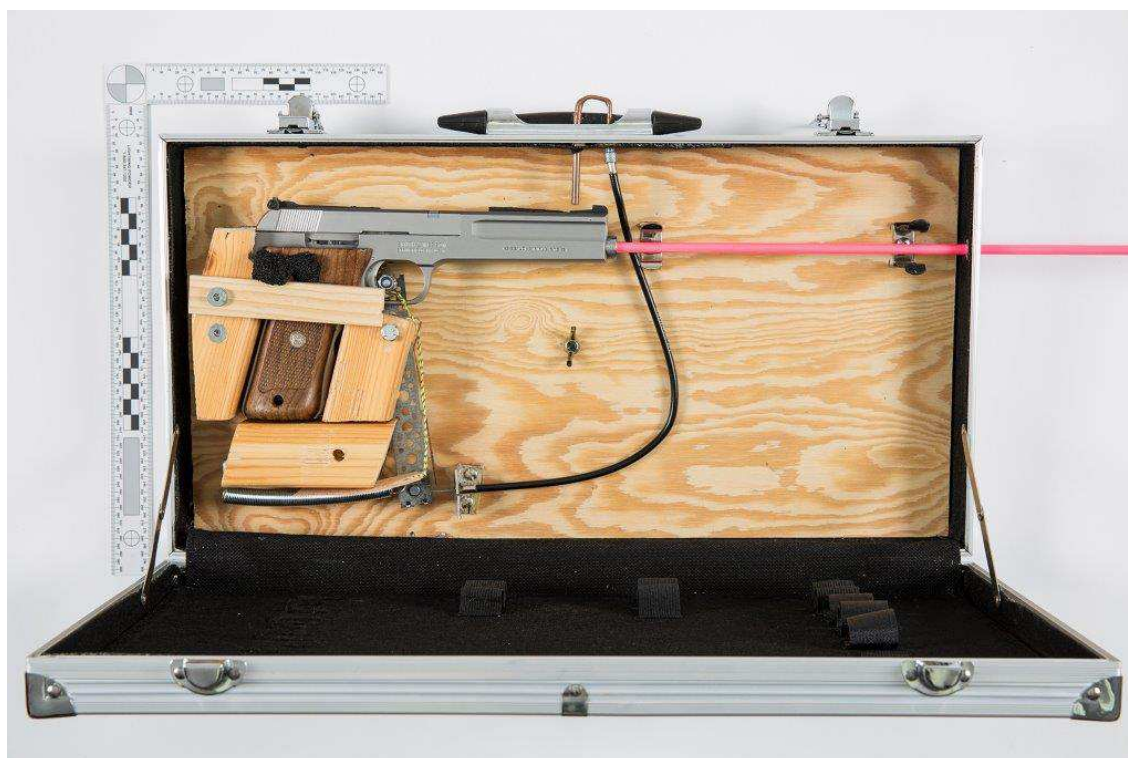
Bild 9. Väskan (G030) med pistolen (G066) monterad. I pipan sitter den en sondpinne som visar pistolens skjutriktning.
