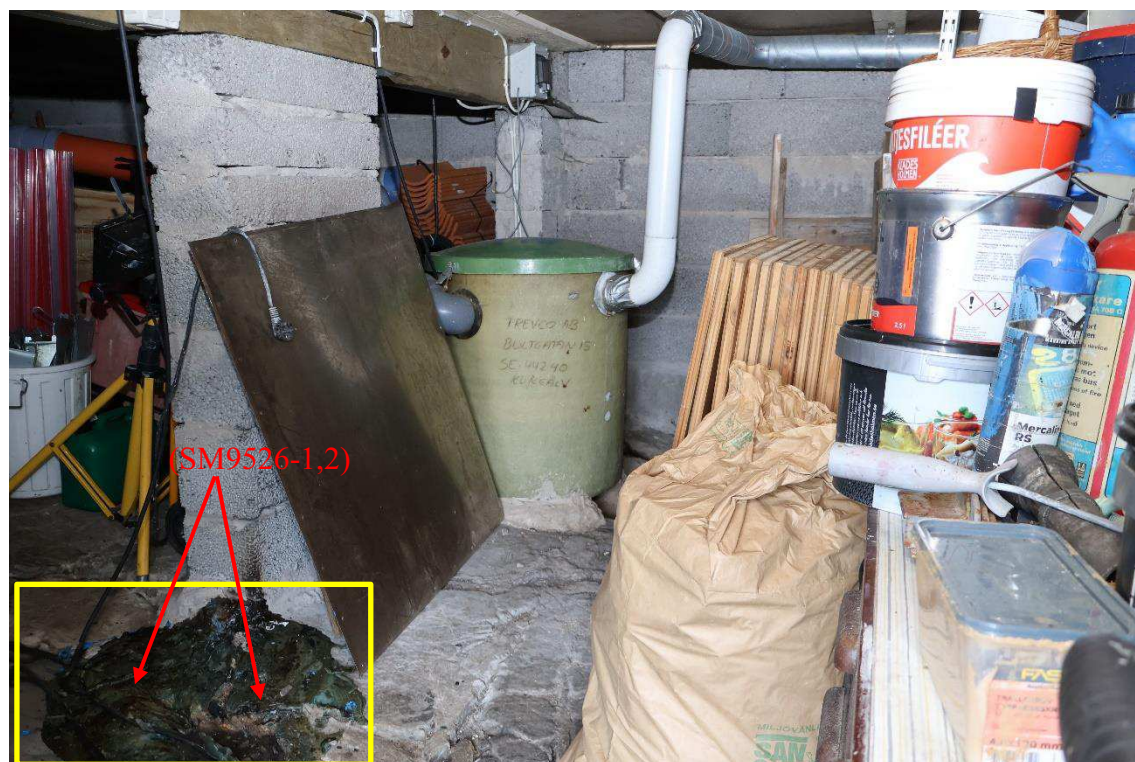
Figur 3. Krypgrunden innanför luckan. Gul markering visar plastsmälta. Röda pilar visar ( SM9526-1,2).
