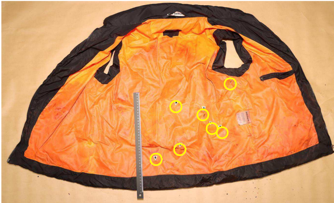
Figur 5. Västens avigsida med genomgående skador markerade med gult på bilden.
