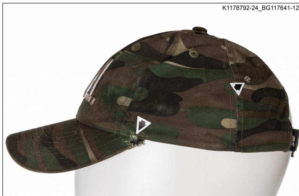
Figur 9. Keps i beslag 2024-5000-BG117641-12, vänster sida. Skador har märkts ut med pilar.
