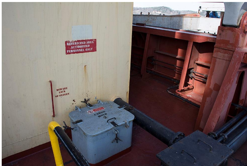
Bild 8 visar nedgången till lastrum 2, vars övre del syns till höger om själva nedgången. Det var genom denna nedgång man tog sig för att komma in i lastrummet
