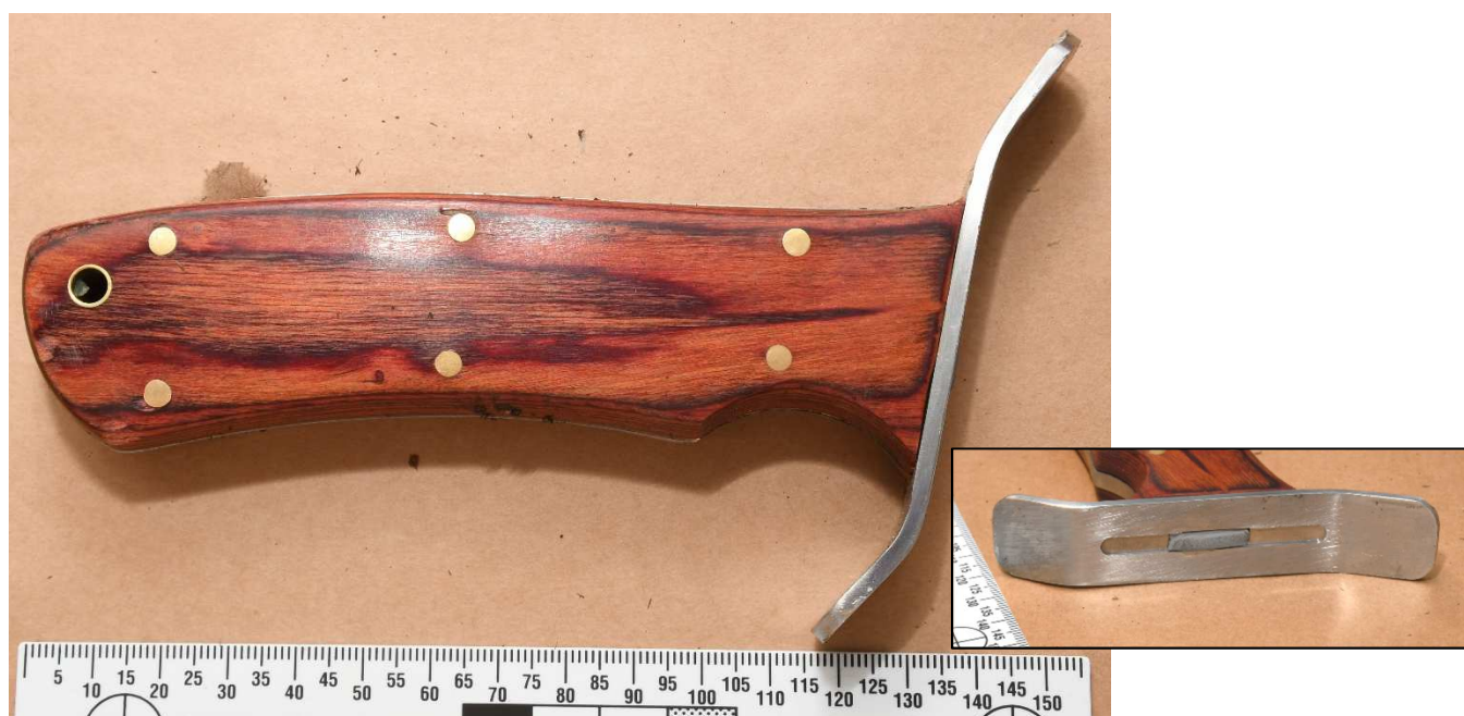
Figur 2. Kniv 2025-5000-BG28999-1. Infälld bild visar brottytan vid knivbladets infästning i handtaget.
