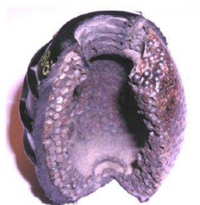
Bild 3 Genomskuren handgranatskropp med stålkulorna exponerade
