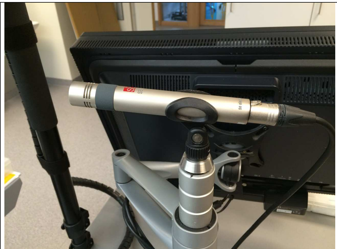
Mikrofonen sitter i ett fäste bakom skärmen på datorn. Själva mikrofonfästet sitter ganska löst. Det går att ändra riktning på mikrofonen med ett finger. Foto, Juan Luis Sanchez
