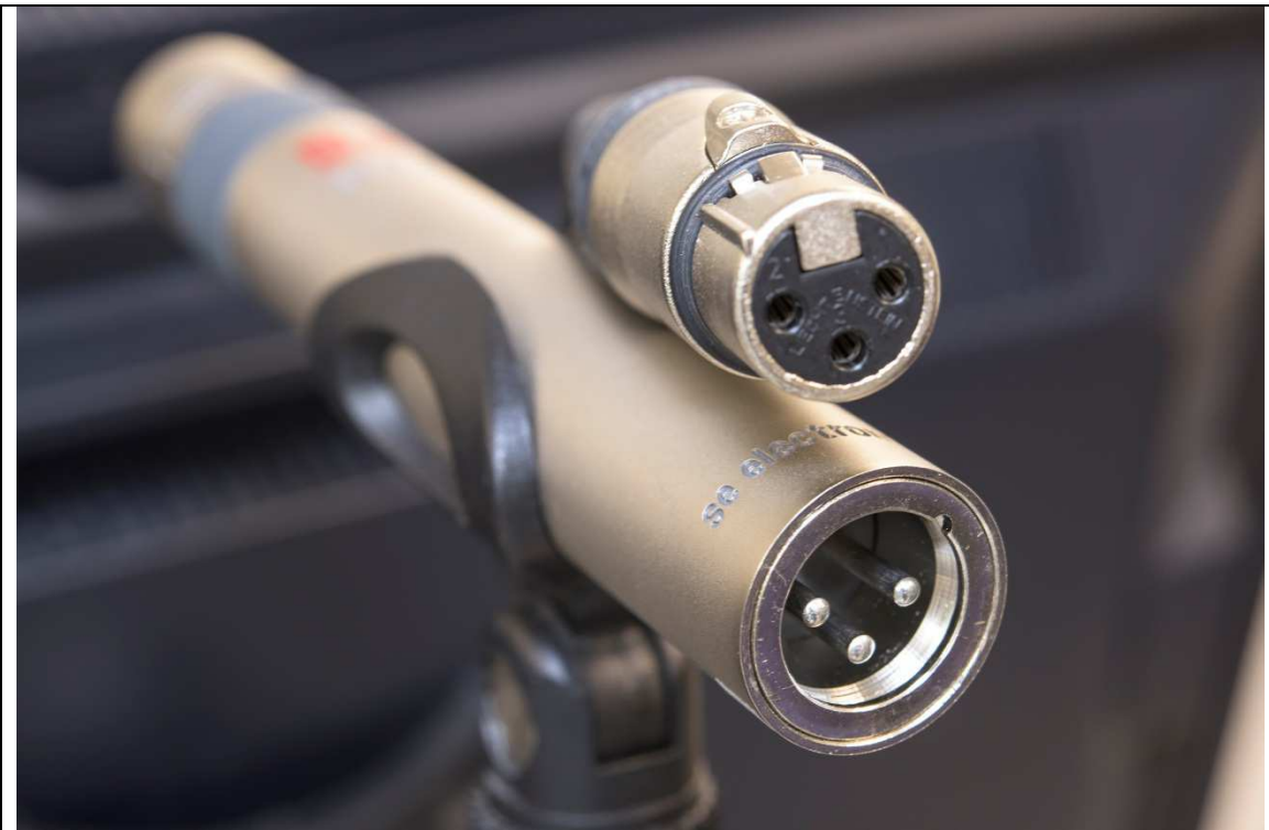
Mikrofonen och mikrofonsladden har så kallade XLR-kontakter med tre stift. Sladden sticks in i mikrofonen och ska låsas fast med en spärr. Foto, Juan Luis Sanchez
