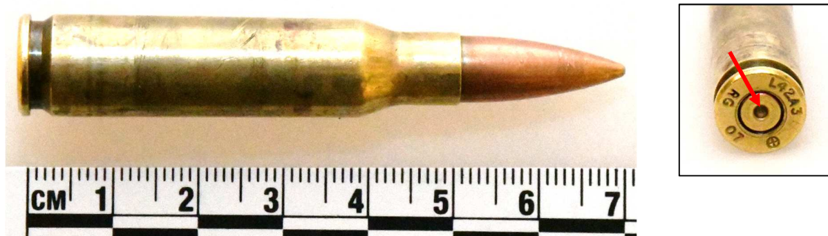
Figur 1. Patron G002. Infälld bild visar tändhatten med dess anslag markerad med röd pil.
