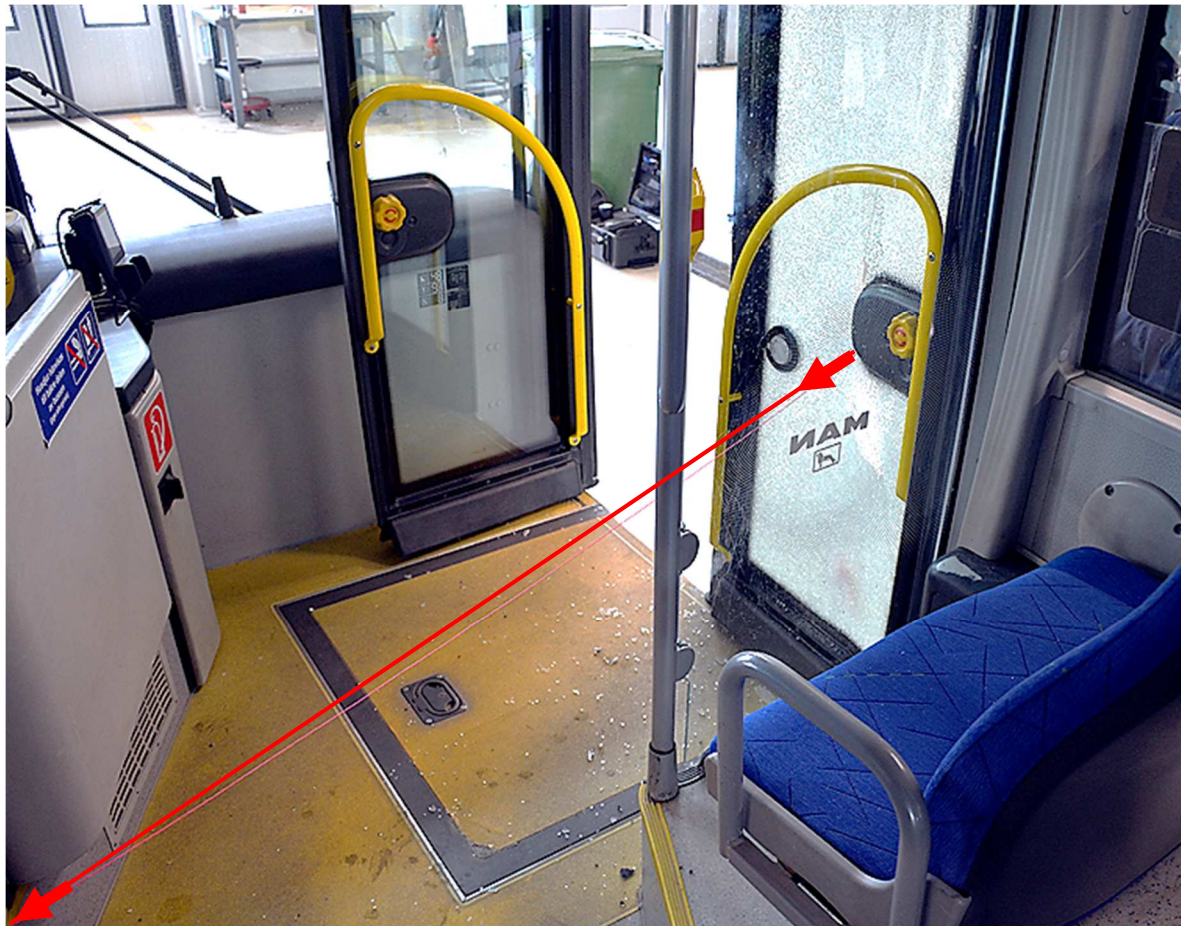
Figur 4 Bussens främre, inre del. Röd markering visar erhållen projektilbana i skada 2 .
