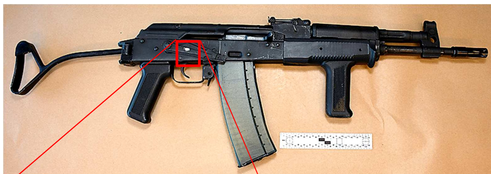
Figur 6 Höger sida av automatkarbin 2023-5000-BG73815, med detalj över synlig vit skada i ytskiktet på patronlägesomställaren.
