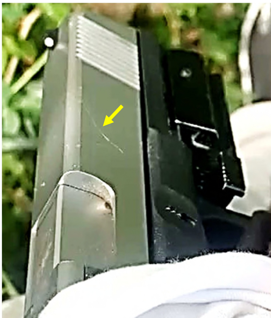
Bild 15 Detalj från bild 10 som visar höger sida av mantelns främre del. Gul pil markerar synlig, tunn repa på mantelns högra sida.
