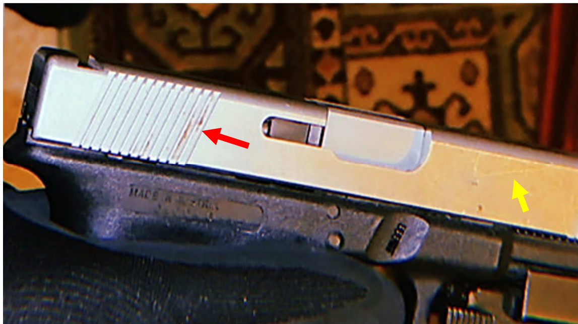
Bild 8 Detalj från bild 5 som visar höger sida av mantelns bakre del. Röd pil markerar synlig besudling. På stommen under manteln ses märkning "Made in Austria". Gul pil markerar synlig, tunn repa på mantelns högra sida.
