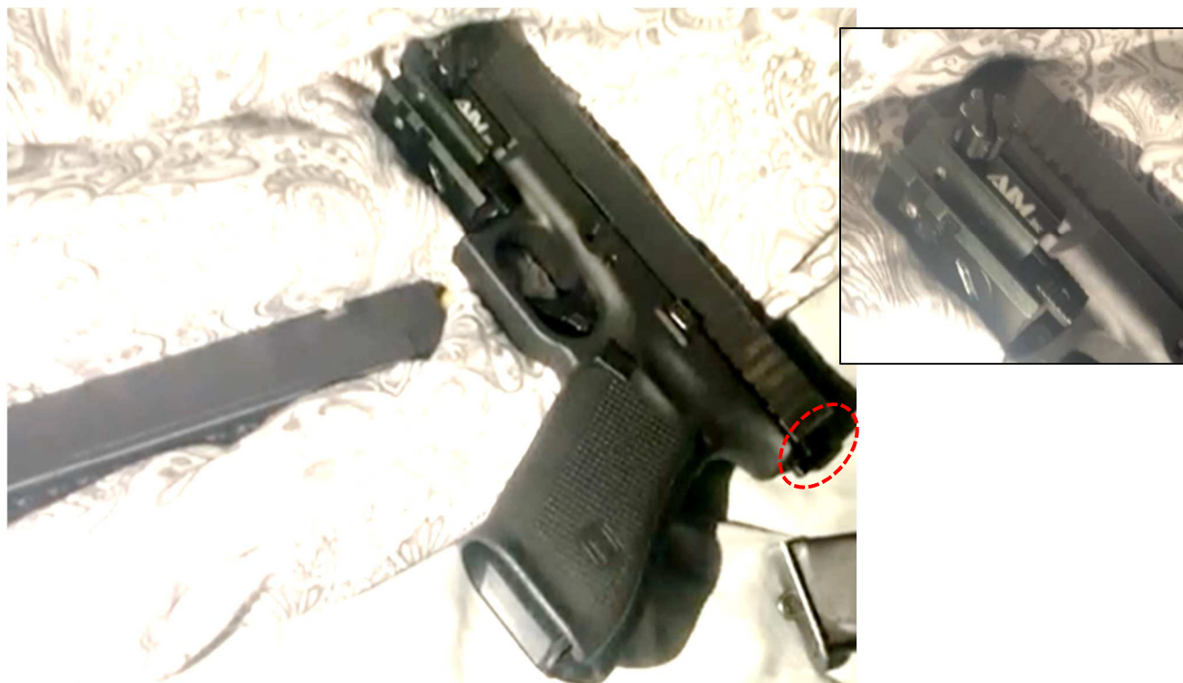
Figur 2. Skärmbild från film S002. Pistol A, med det omnämnda magasinet till vänster. Föremålet på mantelns bakkant är markerat med röd streckad oval. Infälld bild visar mantelns främre del med räfflingen.
