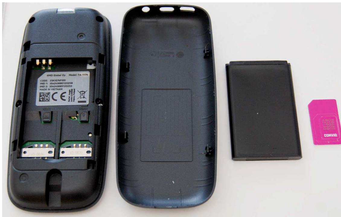
Bild 7. Mobiltelefonen isärplockad med, batteri och sim-kort.
