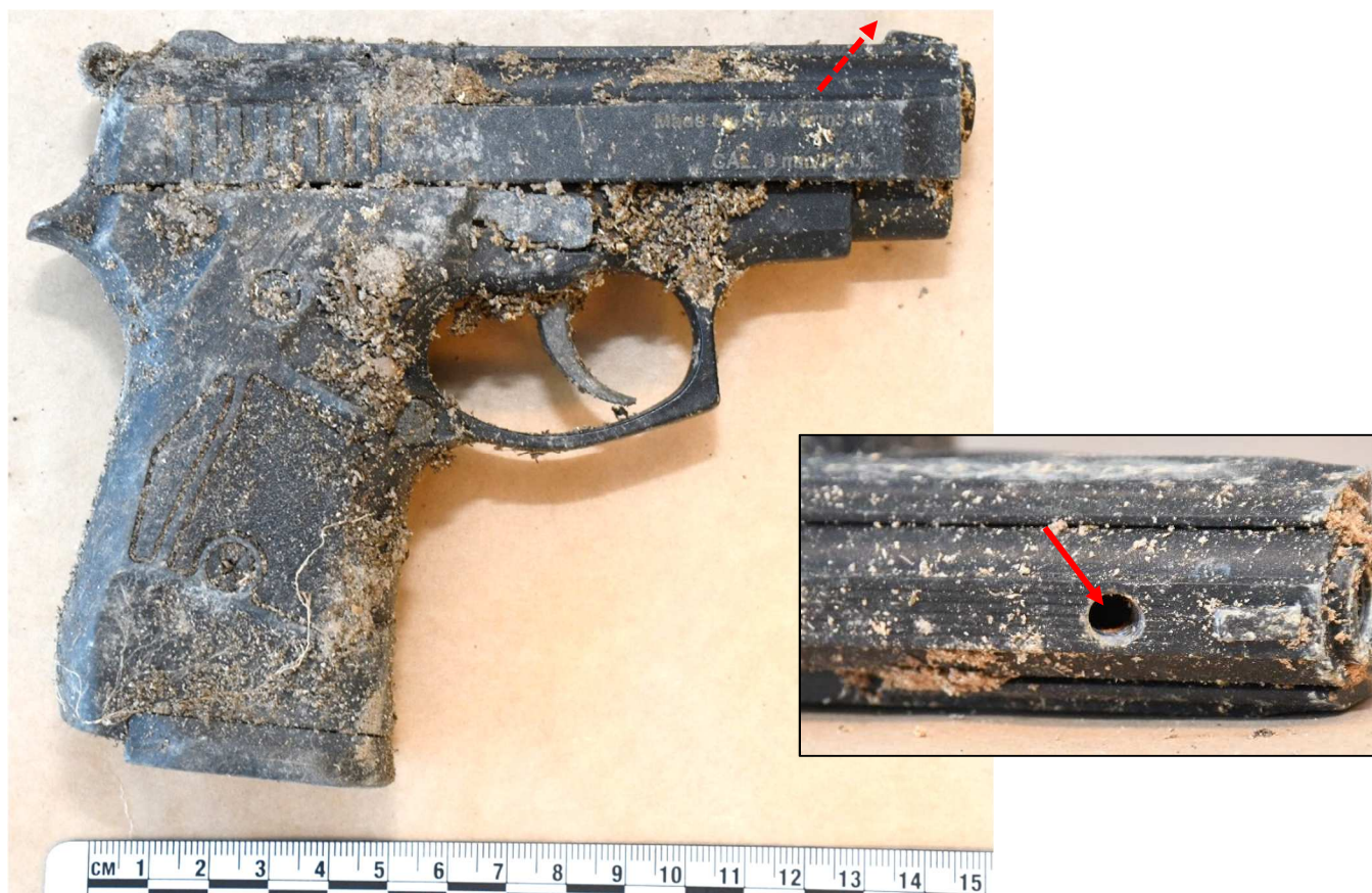
Figur 1. Pistol G009. De röda pilarna markerar det hål som ska avleda krutgaserna. Infälld bild visar pistolen ovansida framme vid siktet.
