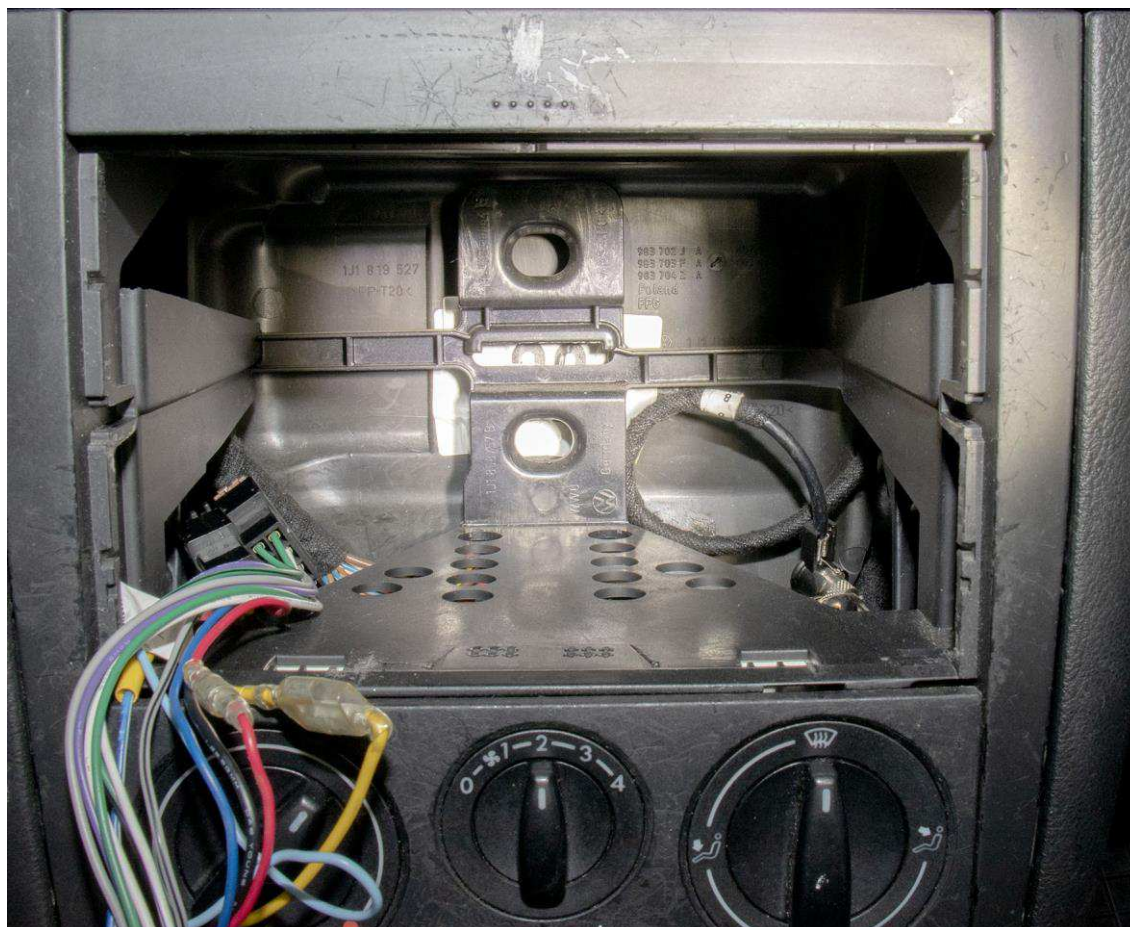
Figur 2. Utrymmet som bildades då både radio och förvaringsfack dragits ut.
