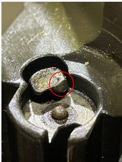
Figur 2. Utdragaren i vapnet 2023-5000-BG110792-1:2 med modifiering/åverkan av typen "svetsloppa".
