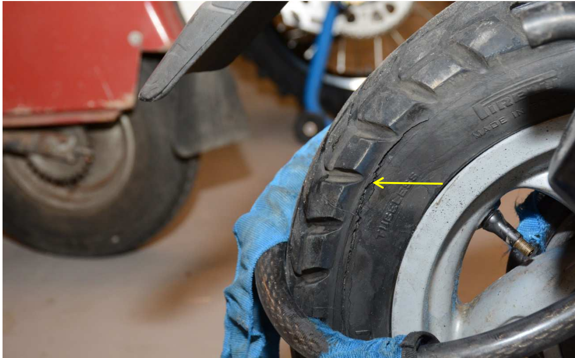
Figur 7. Höger däckssida. Sprickor markerade.
