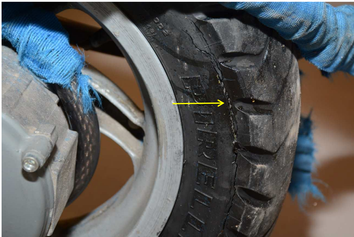
Figur 8. Vänster däckssida. Sprickor markerade.
