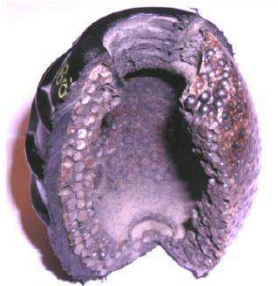
Bild 3 Genomskuren handgranatskropp med stålkulorna exponerade
