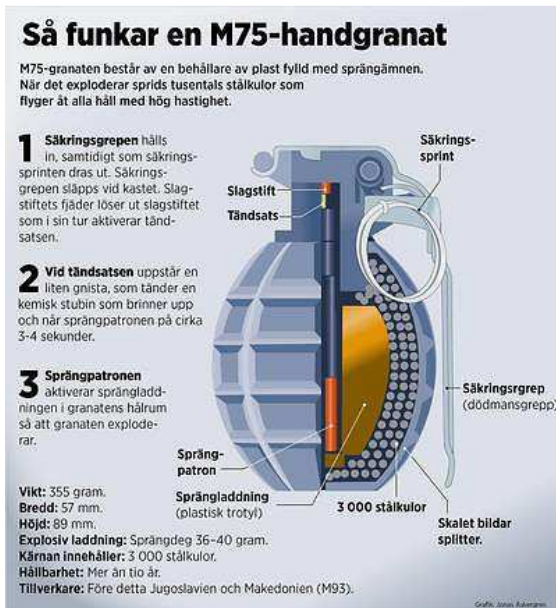
Figur 5. Beskrivning av handgranat M75. Källa: https://www.nyteknik.se/premium/sa-fungerar-handgranaten-m75-innehaller-3-000-stalkulor-6892751 . (2021-01-29).
