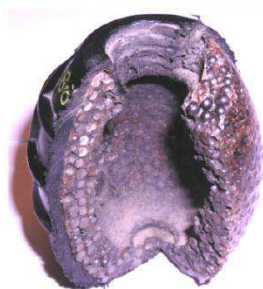
Bild 3 Genomskuren handgranatskropp med stålkulorna exponerade
