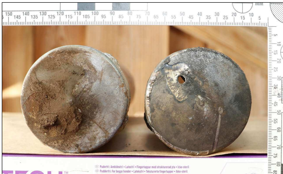
Figur 13. Stolphattarna till rörbomb 2. Notera hålet genom stolphatten till höger i bild, (motsvarande stolphatten till höger i figur 12).
