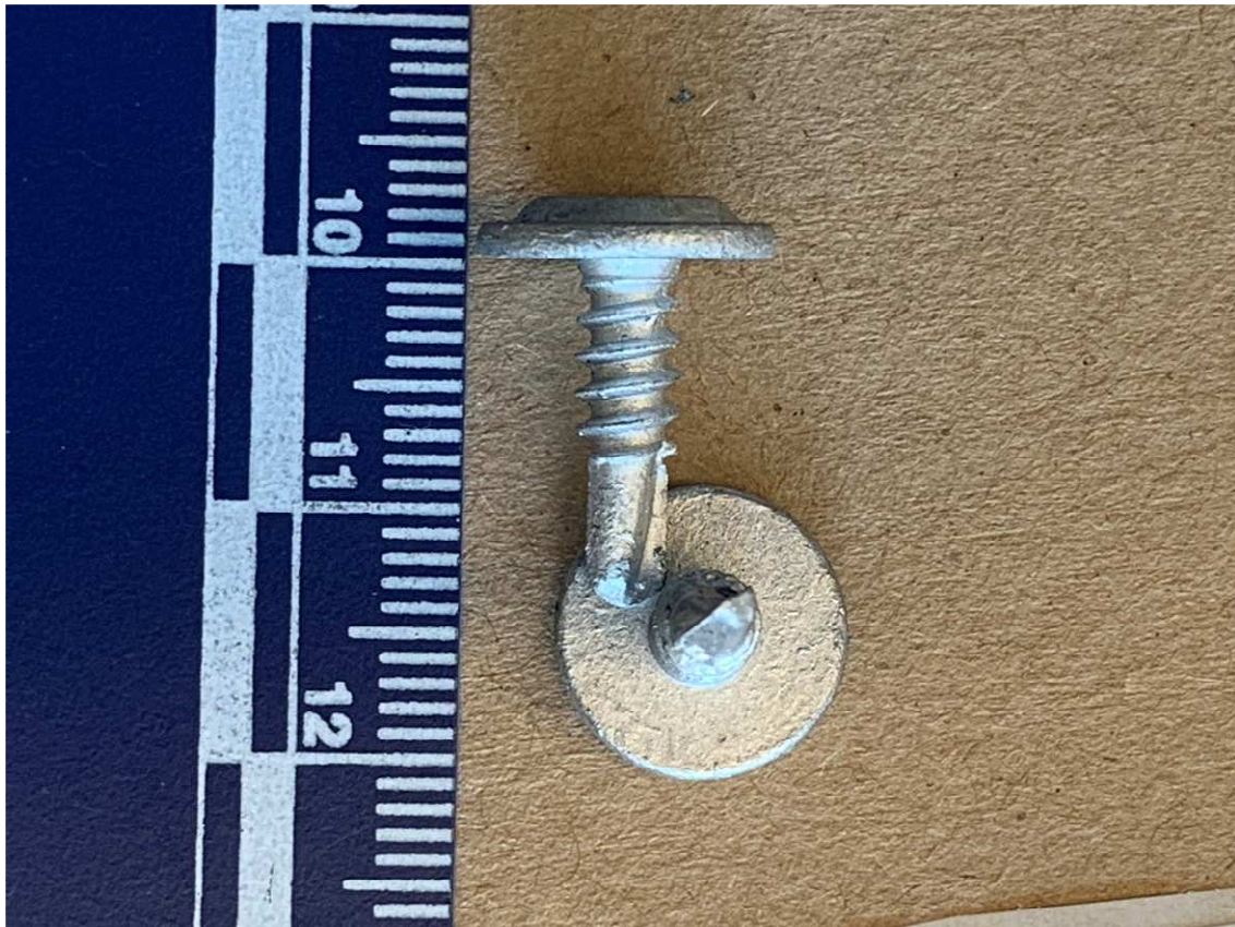
Figur 3. Montageskruv Plåt 4,2X13 som låg i plastmuggen med skruvar. 2023-5000-BG101018-8.
