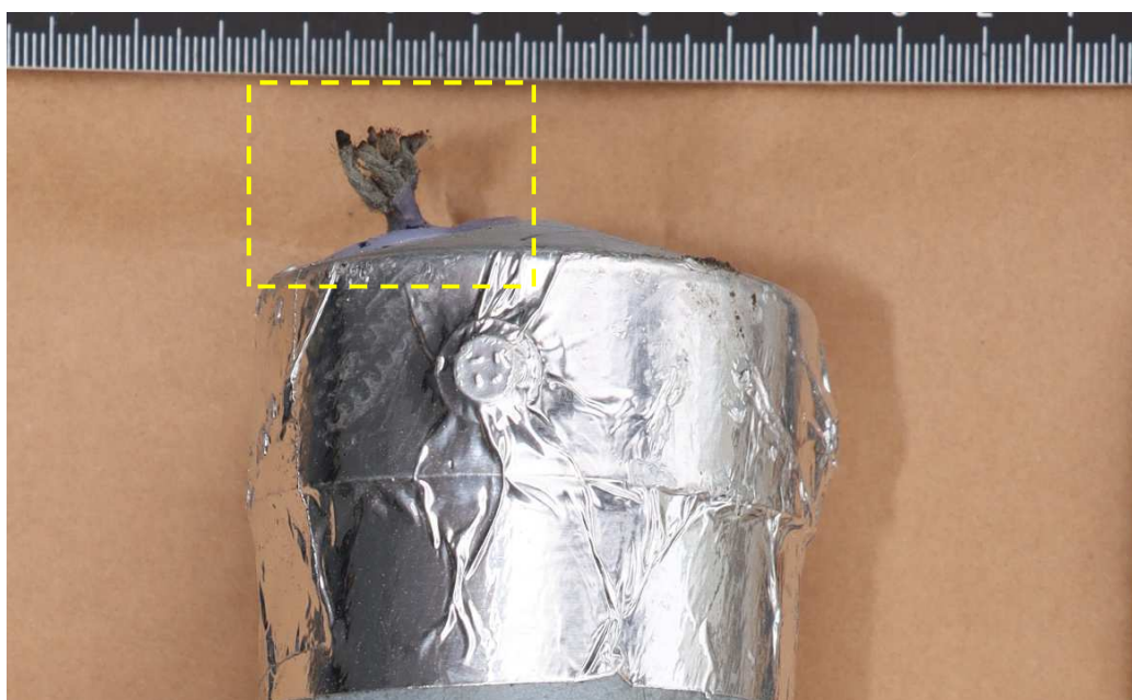
Figur 2. Den stubinliknande garntåden och smältlimmet är markerat.
