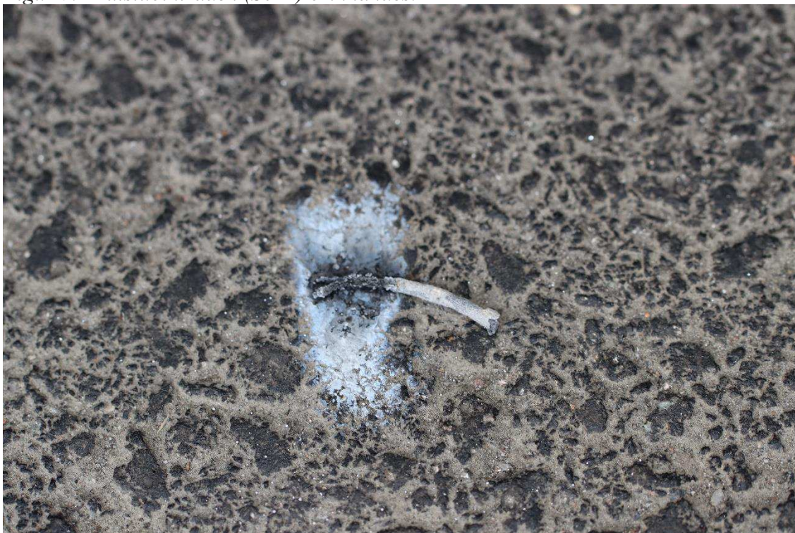
Figur 8. Krutstubintråden (S011) som slocknat utan någon yttre påverkan.
