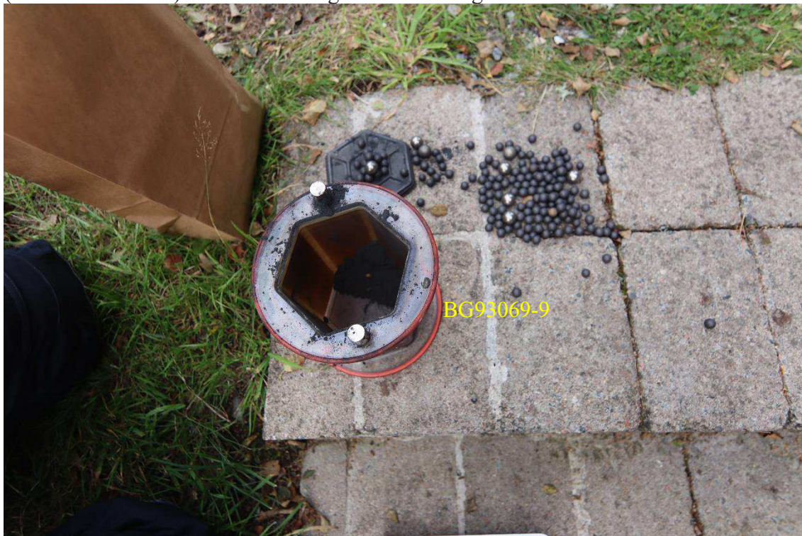
Figur 5. Behållaren från kulkvarnen BG93069-9, på bilden tömd på svartkrutet. Metallkulorna som tumlade krutet i behållaren ses ligga på marken bredvid behållaren.
