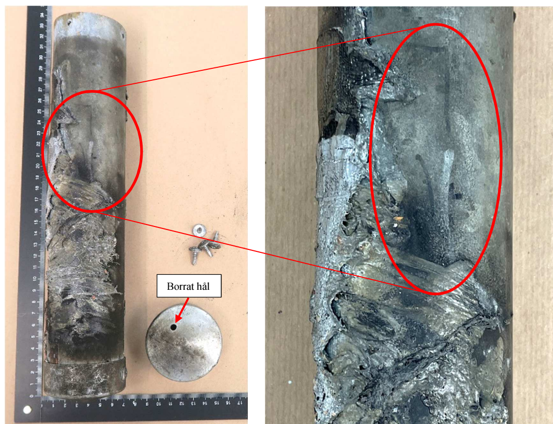
Figur 1. 2023-5000-BG120241-1:1 mitt på röret fanns en markering och i stolphatten fanns ett hål.
