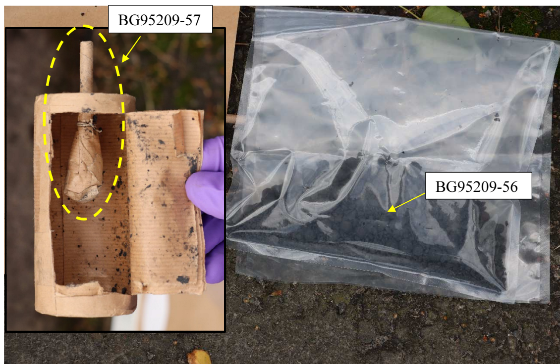
Figur 6. Pyroteknisk pjäs (BG95209-53), tändsats ansluten till en stubin, (BG95209-57), innehållet/pyroteknisk sats (BG95209-56).
