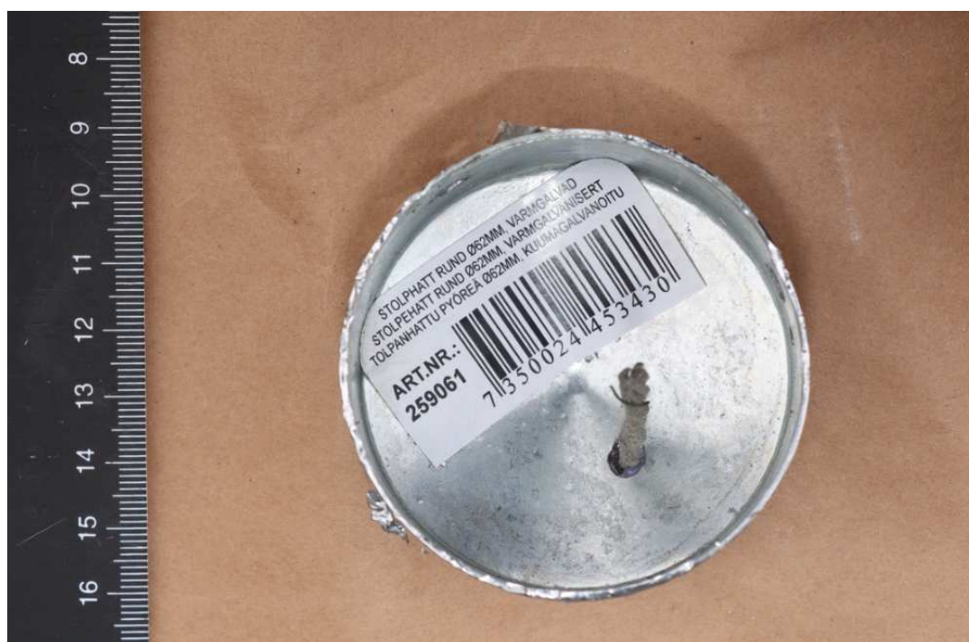
Figur 6. Insida av övre stolphatt. Del av garntråden syns.
