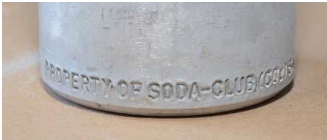
Figur 5. Instansat längst ner på flaskan fanns siffror och text, "292585 KGB 801 PROPERTY OF SODA CLUB (CO 2 ) SA".
