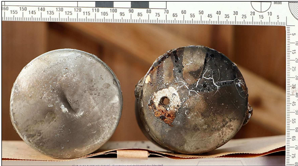
Figur 10. Stolphattarna rörbomb 1. Notera hålet genom stolphatten till höger i bild (motsvarande stolphatten till höger i figur 9).
