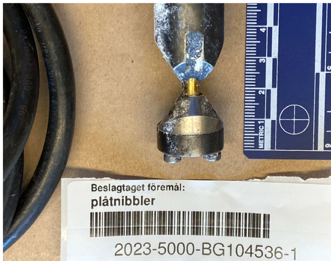
Figur 2, Det fanns inget rester av metallspån
