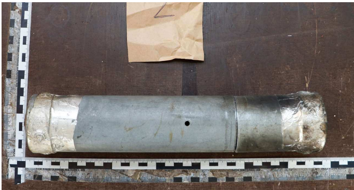
Figur 12. Rörbomb 2 (BG103605-2), öppnad. Notera hålet på rörkroppen.
