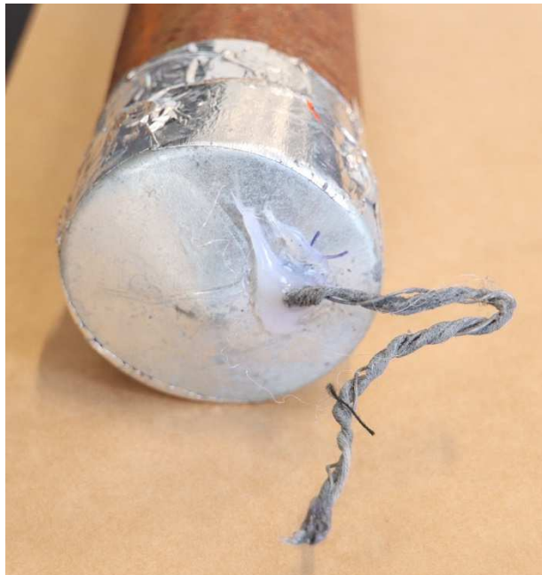
Figur 5 Genom den ena stolphatten satt ett stubinliknande snöre.
