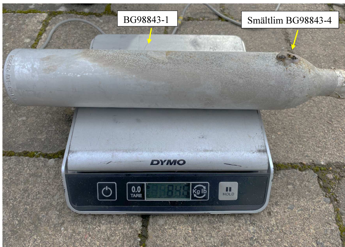
Figur 1. Bild på kolsyreflaskan BG98843-1 fotograferad av bombtekniker. Vågen visar 846 gram. På bilden har inte smältlimmet BG98843-4 lossnat.
