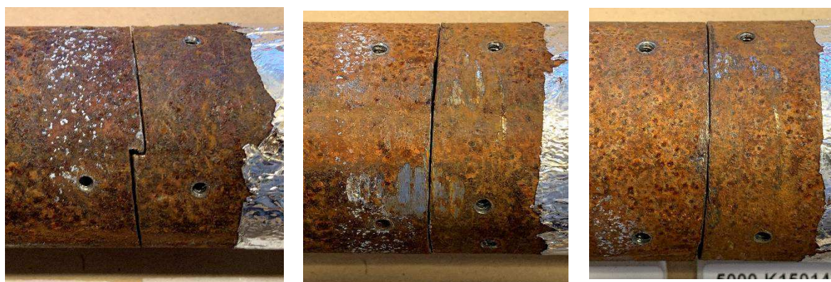
Figur 4. Rördel BG99160-1:5 till vänster och rördel BG139187-2 till höger i respektive bild. Förstoring på snittet mellan rördelarna sett från tre olika vinklar.
