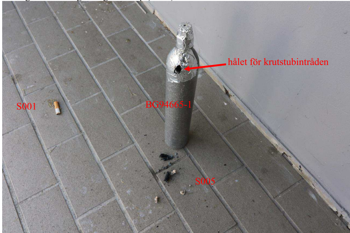
Figur 4. Gasflaskan (BG94665-1), fimpen (S001), Det brända materialet (S005). Hålet för krutstubintråden ses markerat i bilden.
