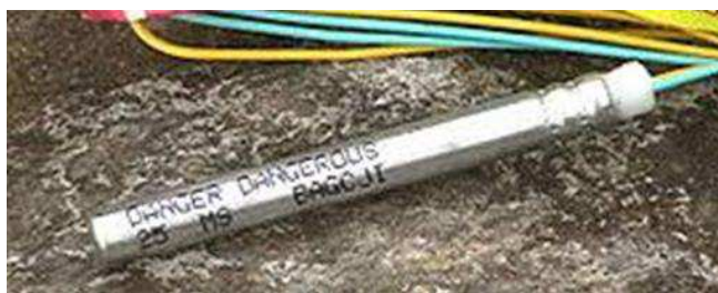
Figur 2. Foto på elsprängkapsel.
