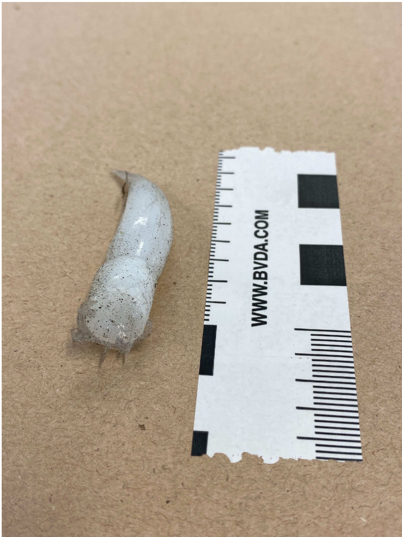
2. Trolig del av limstav fastsmält på motstående trottoarkant
