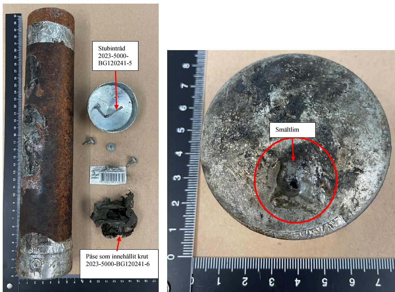
Figur 4. 2023-5000-BG120241:2 i den lösa stolphatten fanns en stubintråd och på ovansidan fanns det smältlim.
