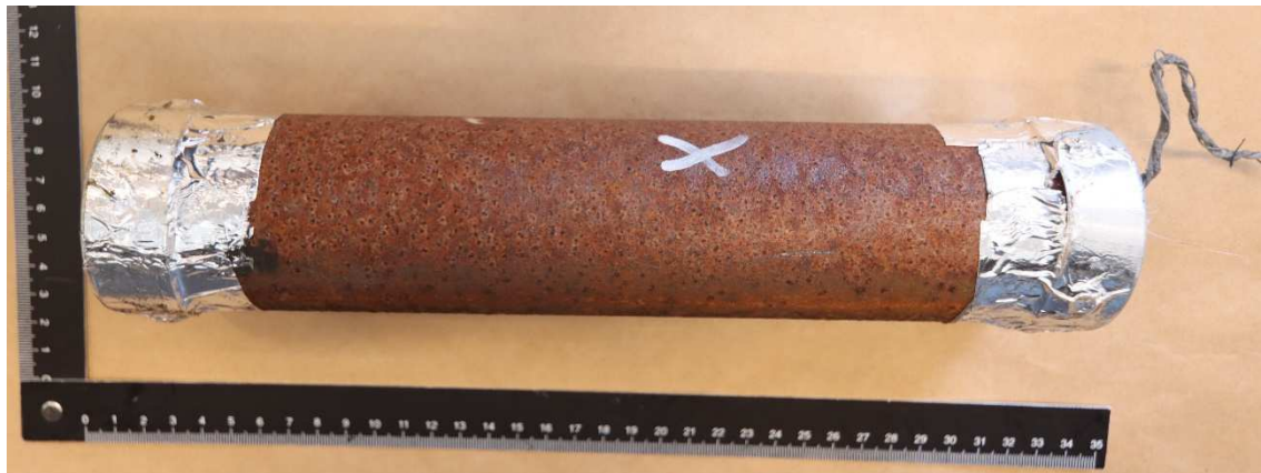
Figur 4 Rörbomb 2023-5000-BG99160-1, ett X var skrivet på röret. Det satt silvrig tejp över skarvarna mellan stolphattarna och röret.
