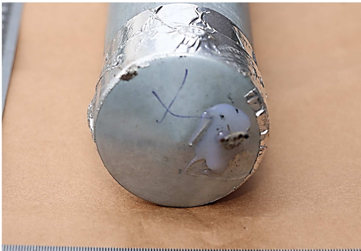
Figur 3. Övre kortsida/stolphatt, stubinliknande garnråd, smältlim och blått X.
