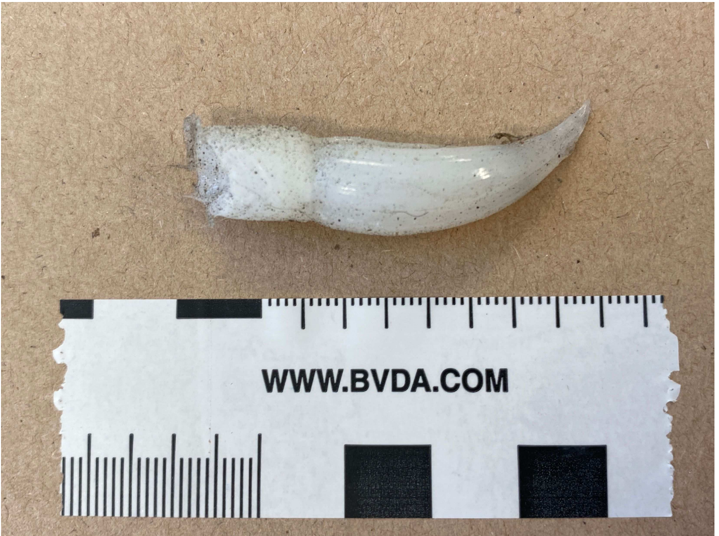
1. Trolig del av limstav fastsmält på motstående trottoarkant
