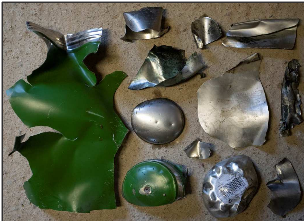
Ihopsamlad splitter från termos efter att en "termosbomb" exploderat
