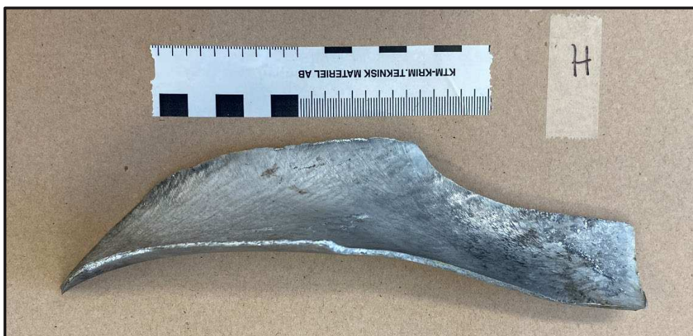
Exempel på splitter från en kolsyreflaska med krut som exploderat.
