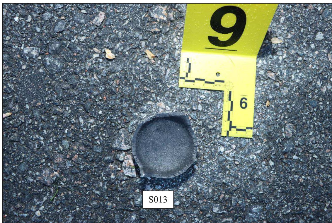
Figur 21. Närbild på botten på en kolsyrepatron (S013). Siffran 9 är en markeringsskylt.
