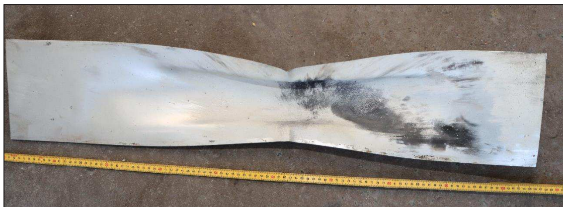
Figur 11. Närbild på frontplåten med intryckning och sotplym. En tumstock är placerad i bilden.
