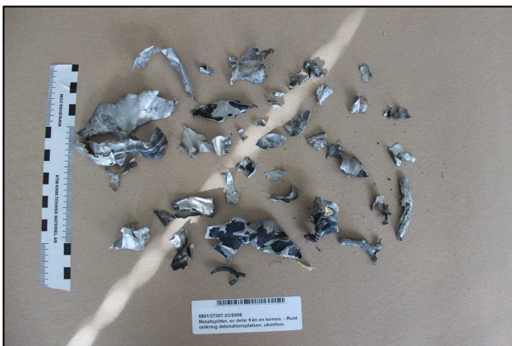
Exempel på splitter från en termos med krut som exploderat
