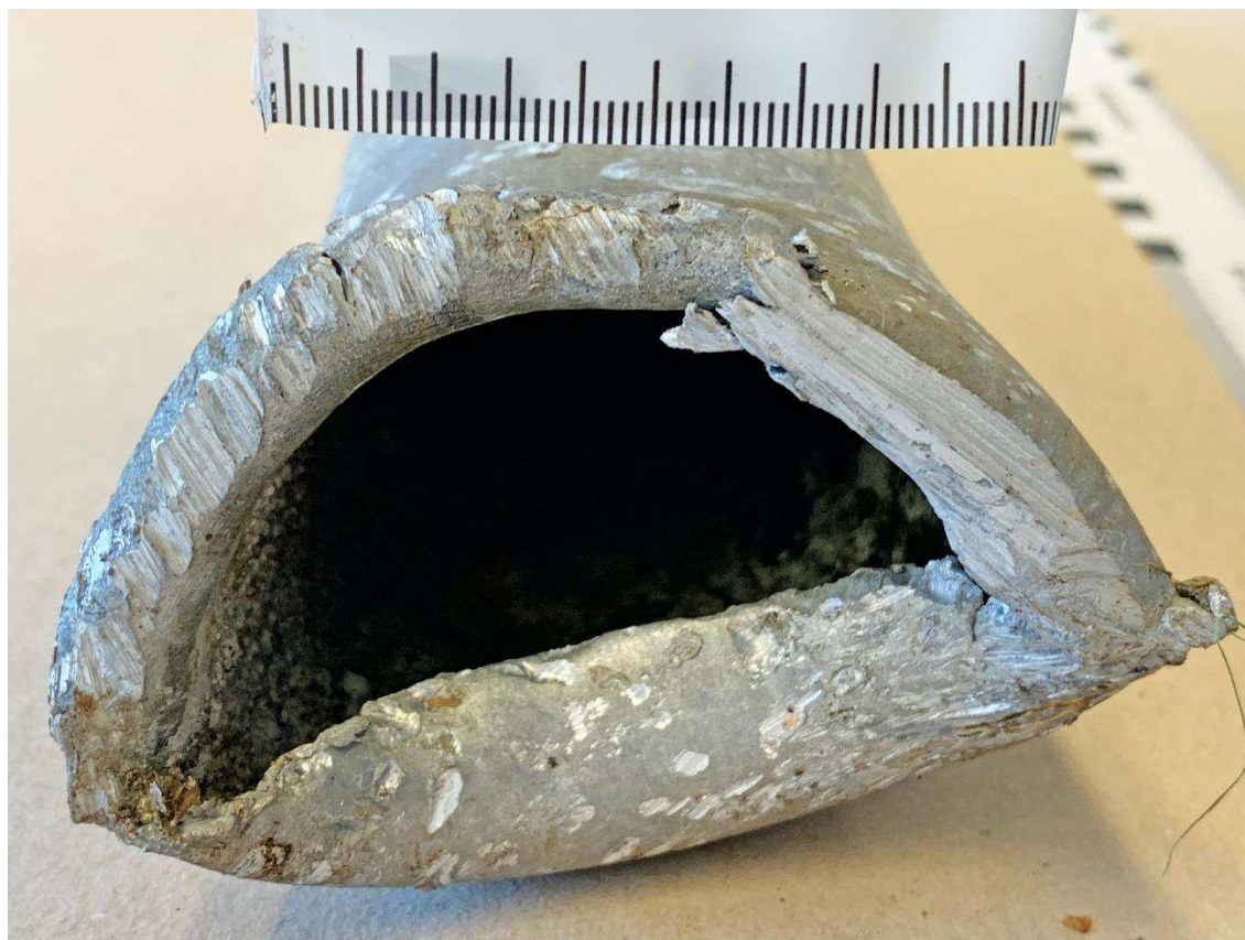
Figur 6. Kolsyrepatronens botten saknas.
