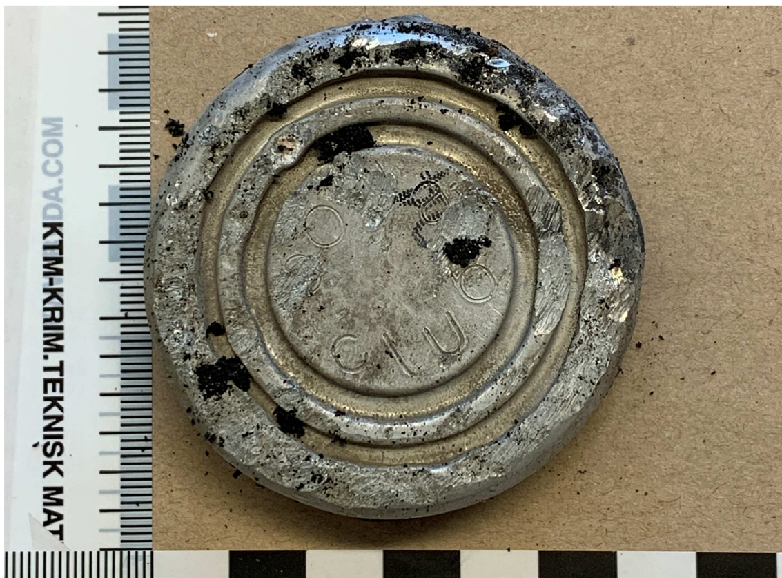
Figur 8. Bild på metallsplitter 2023-5000-SM232-2 botten till kolsyrepatron.
