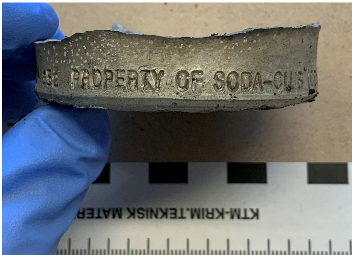
Figur 7. Bild på metallsplitter 2023-5000-SM232-2 botten till Kolsyrepatron. Cirkulär del, bedömd botten på aluminium-kärl för CO 2 . Skrift på sidan "PROPERTY OF SODA-CLUB" (CO 2 ).
