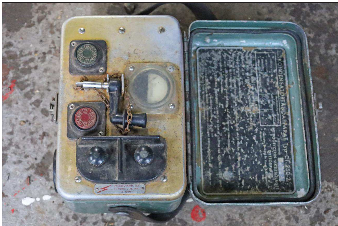
Figur 53. Tändapparat (2025-5000-BG4536-48). Benämningen på insidan av locket var "KONDENSATOR TÄNDAPPARAT typ C1 250-2" "Serienummer 1624".
