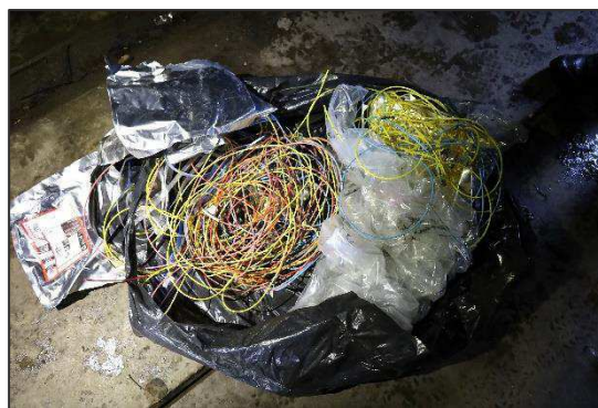
Figur 23. Sopsäcken med tomma förpackningar och rester av stötvågsledare.
