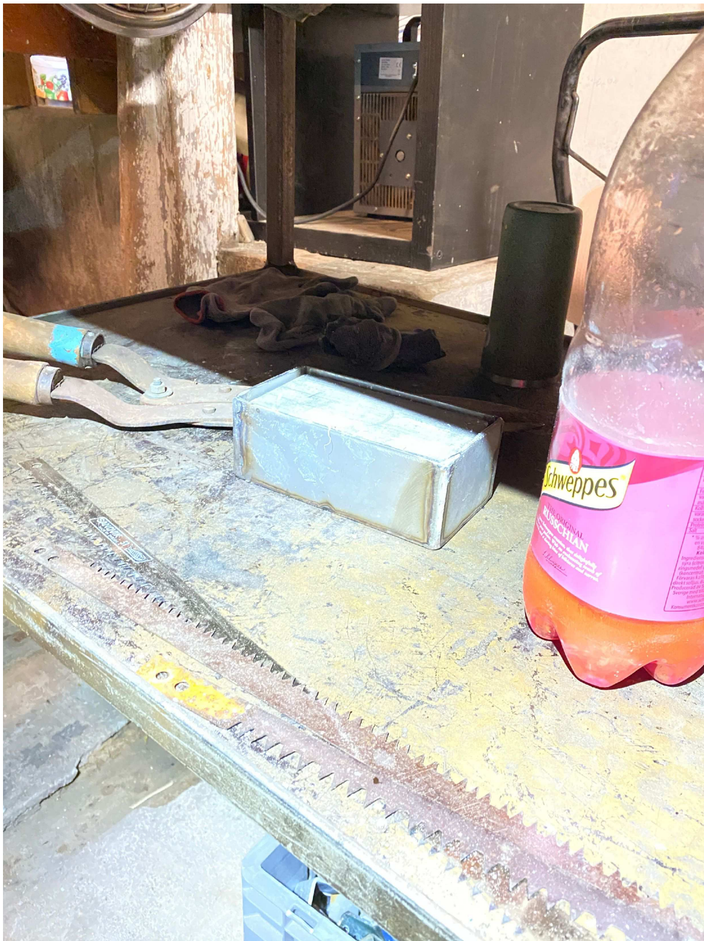
14. ihopsvetsad "plåtask" under bordet. BG56212-73.
