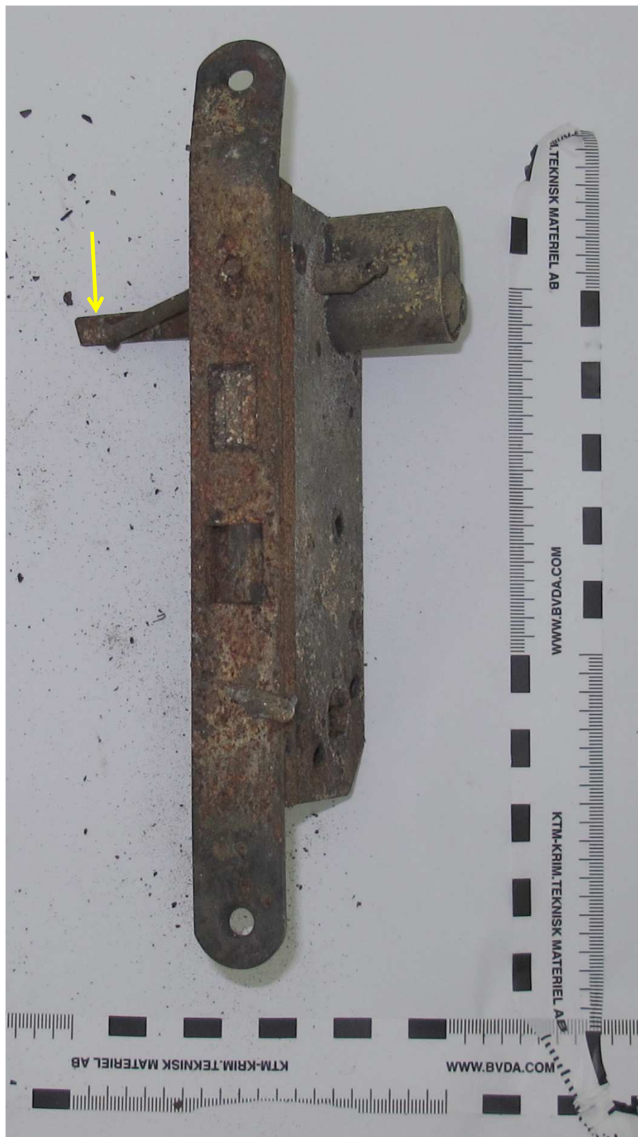
Bild 15. Fallregellåset har varit försett med vred på insidan.
