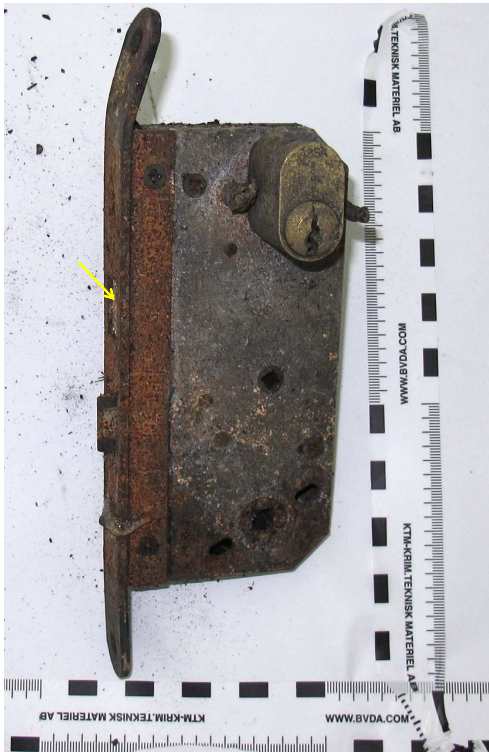
Bild 14. Fallregellås 5701/31028-15/S009 till högerhängd dörr. Låskolven är i upplåst läge. För att kunna låsa eller låsa upp ett sådant lås utifrån krävs dörrnyckel.
