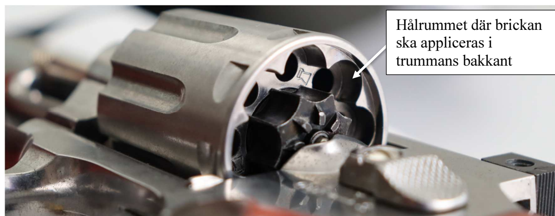
Figur 2. Trummans bakkant, vit pil markerar det bågformade hålrummet.
