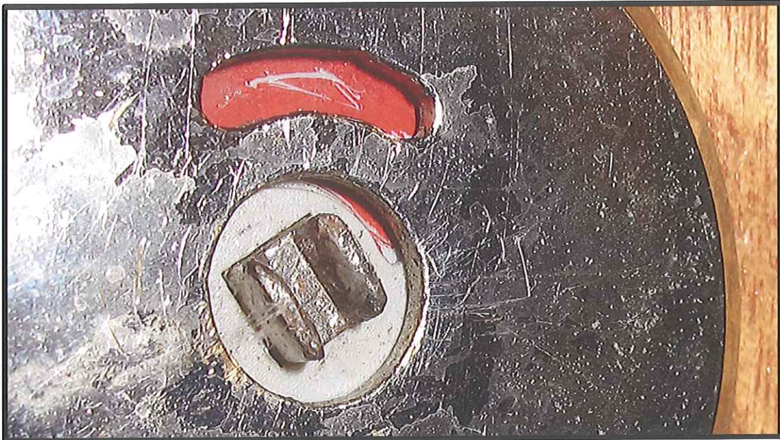
Foto 55, visar repor i låsets "markeringsfönster"
