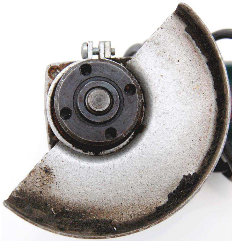
Bild 2. Infästning av slipskiva.
