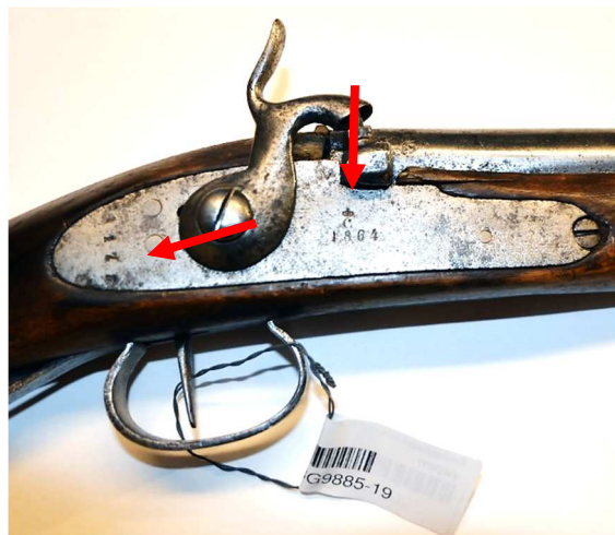
Figur 5. Märkning på baskylens/låsbleckets högra sida. En kungakrona med ett "C" samt daterat/år "1864". Serienummer är sannolikt "821".
