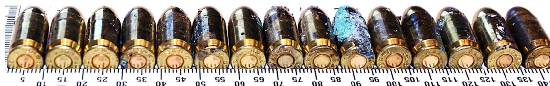
Figur 14. Patronernas tändhattar var intakta dvs. ej initierade.
