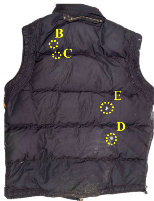
Figur 17. Dunvästens (G019) baksida. Skadorna (B-E) är markerade.
