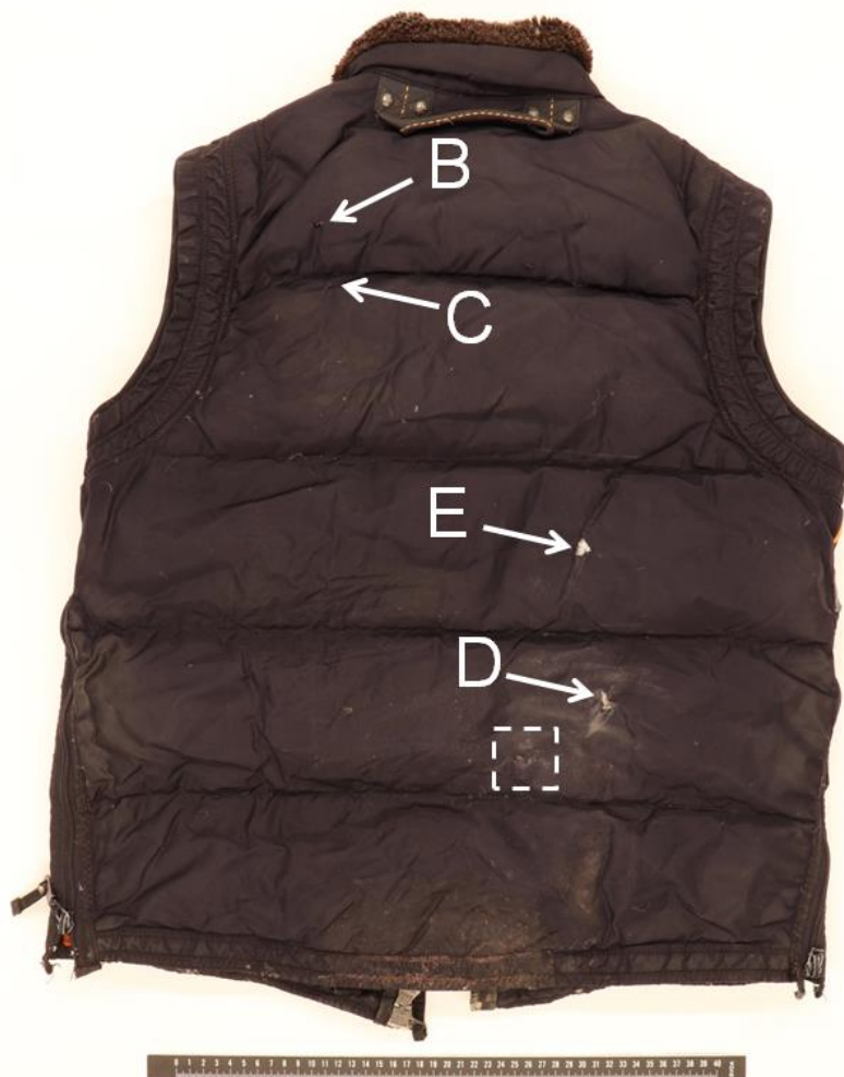
Figur 2. Västens bakstycke med skadorna B-E utmarkerade med pilar. Det samlade området med småskador har ringats in.
