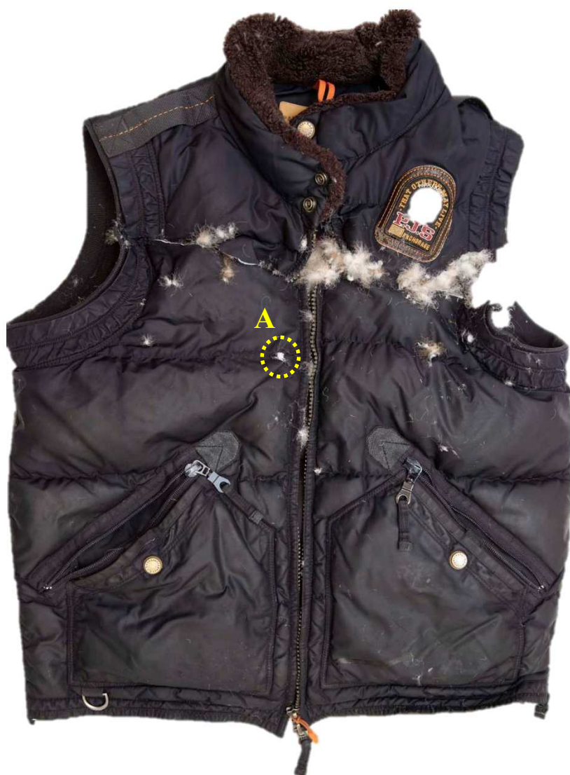
Figur 1. Dunvästens (G019) framsida. Den genomgående skadan (A) i högra framstycket är markerad.
