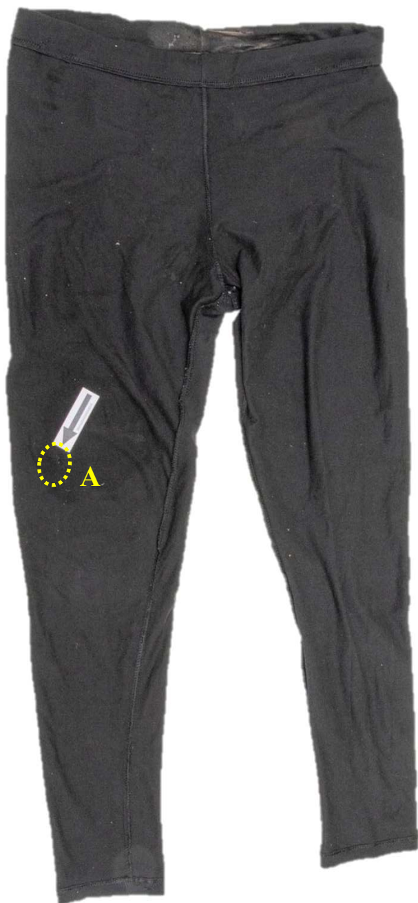
Figur 12. Långkalsongernas (G025) framsida. Den genomgående skadan (A) i högra framstycket är markerad.
