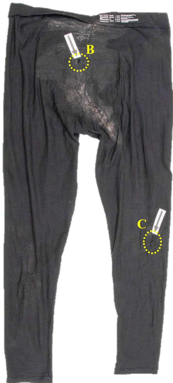
Figur 13. Långkalsongernas (G025) baksida. De två genomgående skadorna (B-C) är markerade.
