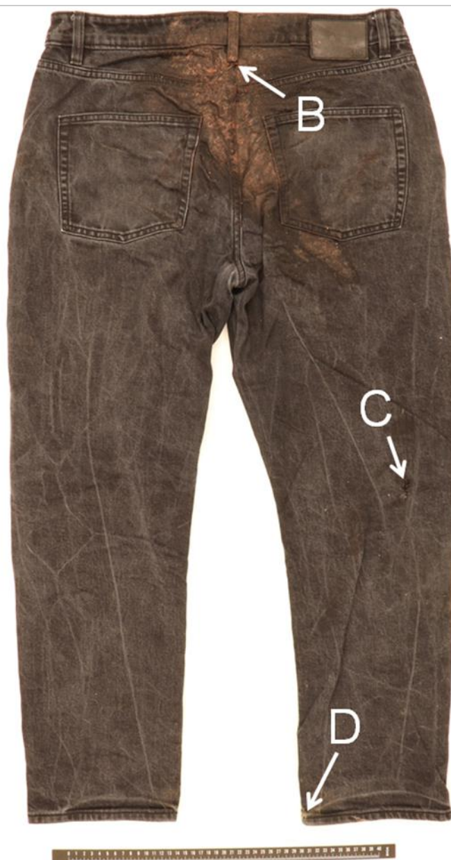
Figur 5. Byxornas baksida med skadorna B-D utmarkerade med pilar.
