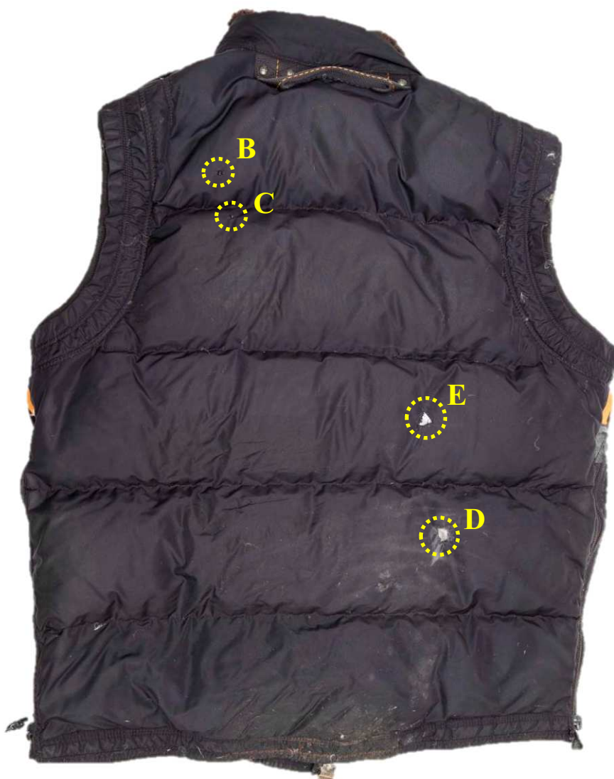
Figur 2. Dunvästens (G019) baksida. De iakttagna skadorna (B-E) är markerade.
