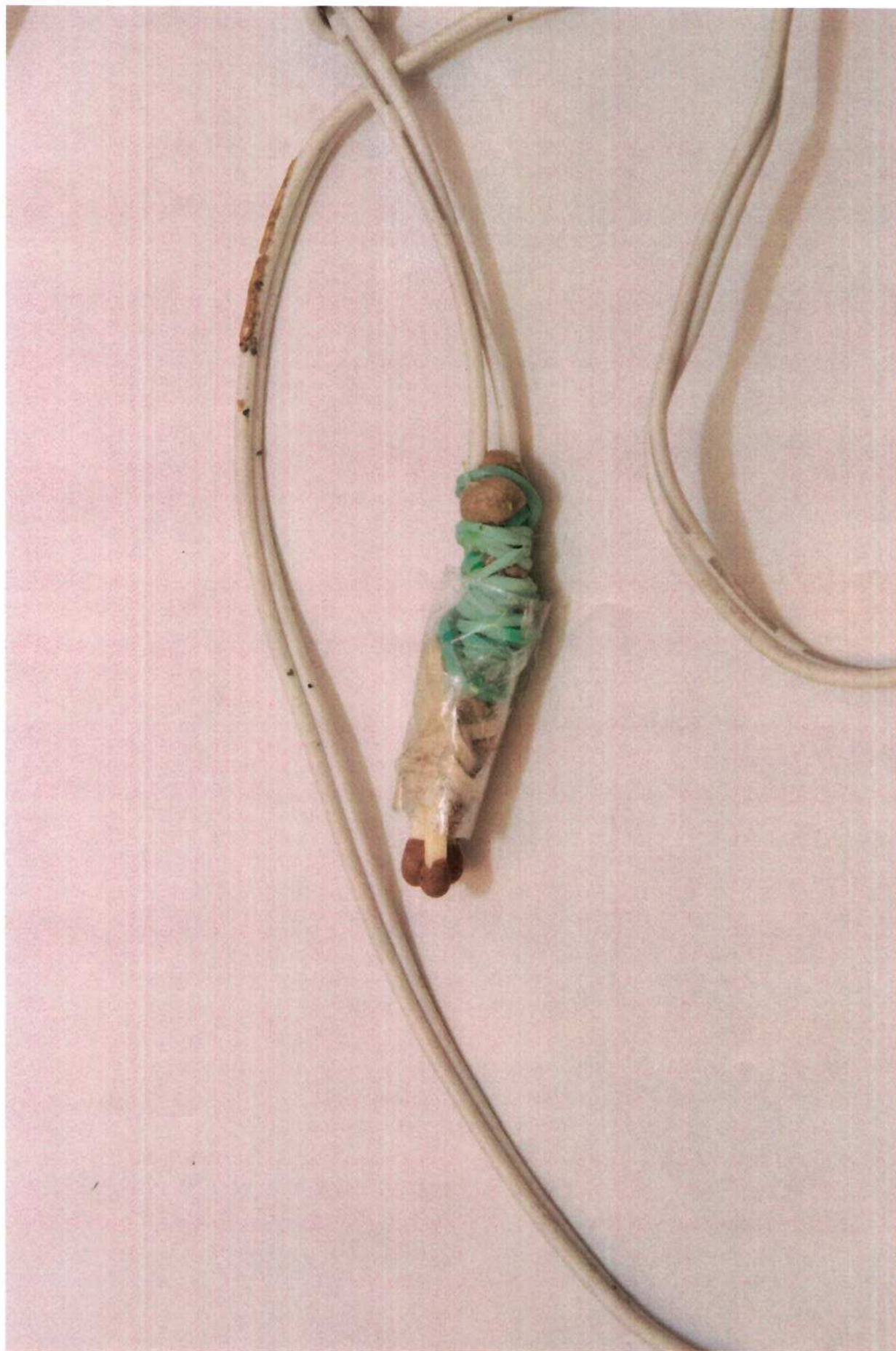
4. Beslag 2022-5000-BG10288-18 (G021) Hemmabygge. Elkabel med koppartrådar mot tre avbrutna tändstickor som tejplats ihop. Gummisnodd och ev tuggummi(?).
