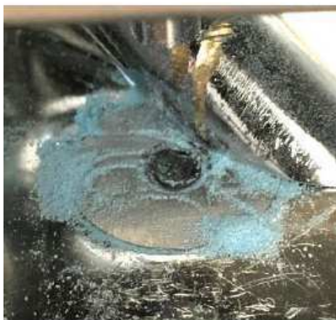
Bottenplatta, undre stans samt påfyllningsföt, tablettmaskin 2022-5000-BG11525-8:1
