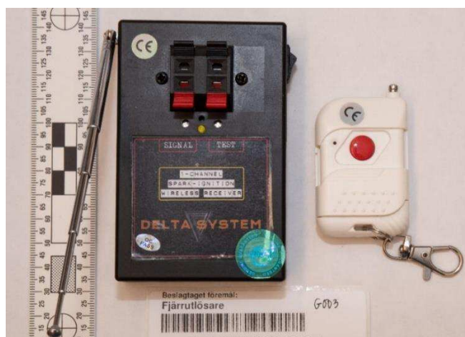
Figur 27. Närbild på fjärrutlösarens båda delar (sändare och mottagare).
