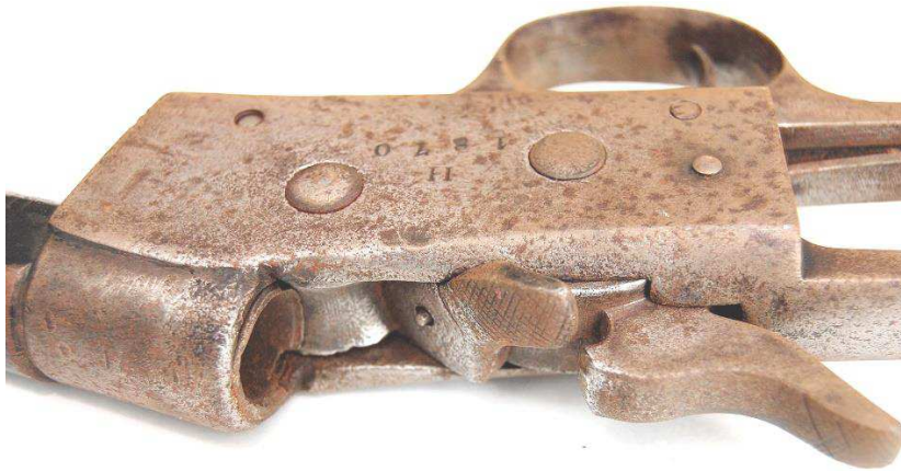
Bild 5. Patronläget, med öppnad laddlucka, spetsen på tändstift och spänd hane.
