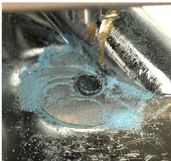
Bottenplatta, undre stans samt påfyllningsfot, tablettmaskin 2022-5000-BG11525-8:1
