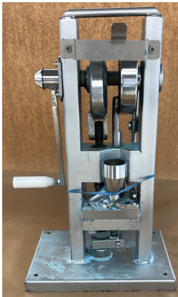
Baksida tablettmaskin 2022-5000-BG11525-8:1. Tablettmassa fylls på i tratten i mitten på maskinen.
