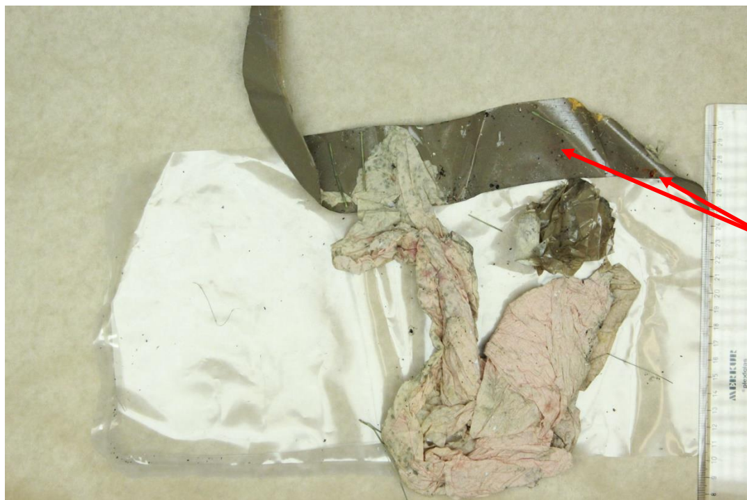
Figur 8. Materialet BG112053-5 när det vecklats ut. Ett flertal fibersamlingar, bestående av orangea/röda fibrer och mörka fibrer, iakttogs på klistriga ytorna. Pilarna pekar på synliga orangea/röda fibersamlingar.
