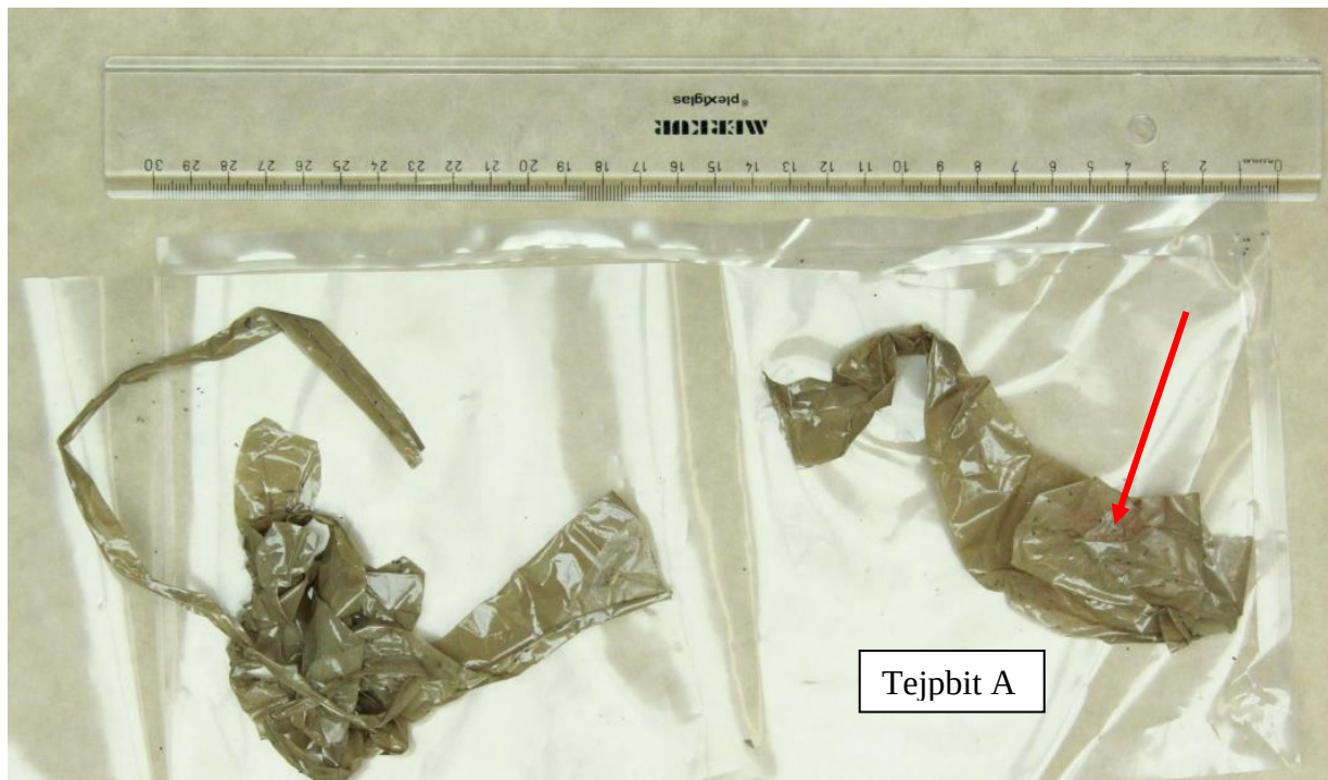
Figur 4. Två av tejpbittarna från BG112053-3 när tejpbitt A vecklats ut. Den klistriga ytan ligger uppåt. På tejpbitt A iaktogs orangea/röda fibersamlingar på den klistriga ytan. Pilen pekar på synliga orangea/röda fibersamlingar. På övriga tejpbitar i materialet BG112053-3 iaktogs fibersamlingar som innehöll mörka fibrer.
