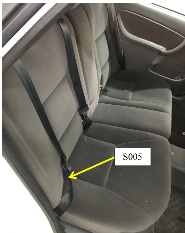
Bild 3. Handtaget på säkerhetsbältet topsades, S005.
