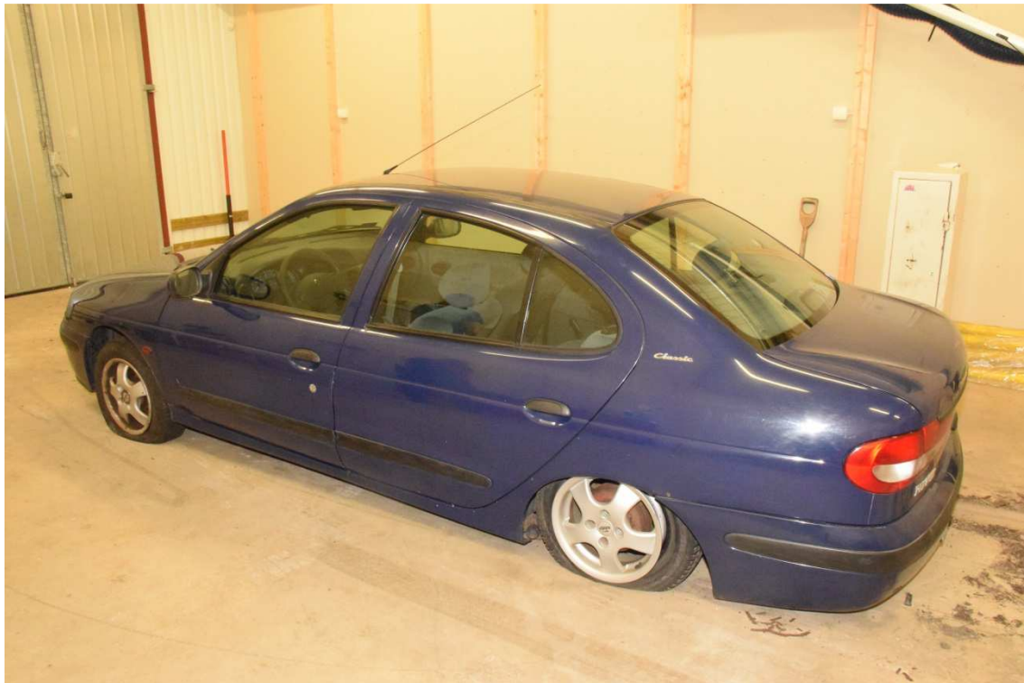
Bild 2 visar vänstersidan. Båda däckerna är skadade och saknar luft.
