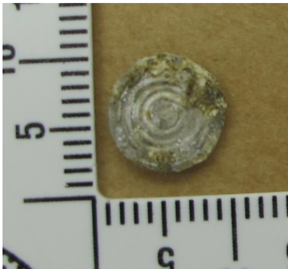
Bild 1 och 2. Båda sidorna av metallbiten 5617/30613-19/G024. I mitten på bild 2 finns en rund brottyta.
