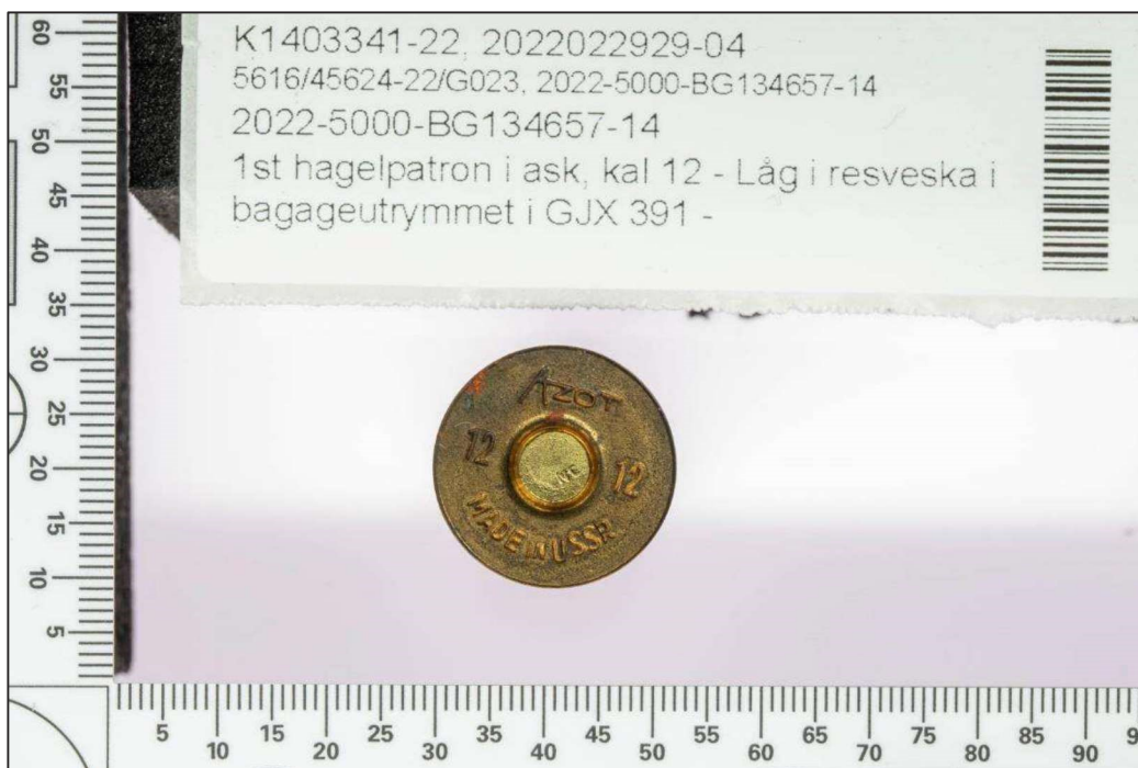
Bild 3 Översiktspå hagelpatronens bottensockel, även kallad culot. I botten är det instansat Azot, 12 samt made in USSR. I mitten sitter tändhatten.
