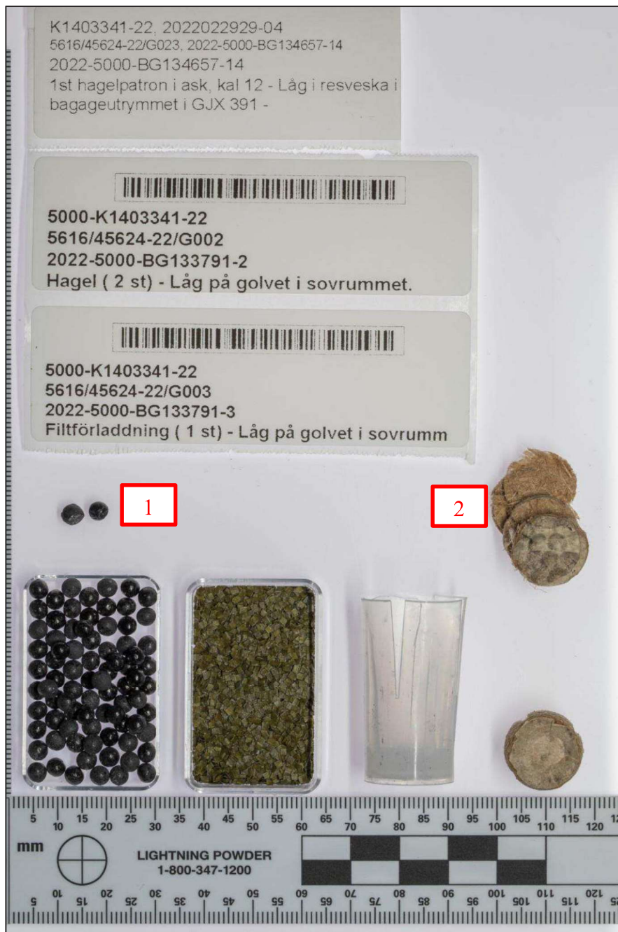
Bild 5 Översiktsbild där innehållet i hagelpatronen plockats ur, nedre raden. Markeringarna visar hagel och filtförladdning som säkrats på brottsplatsen.
