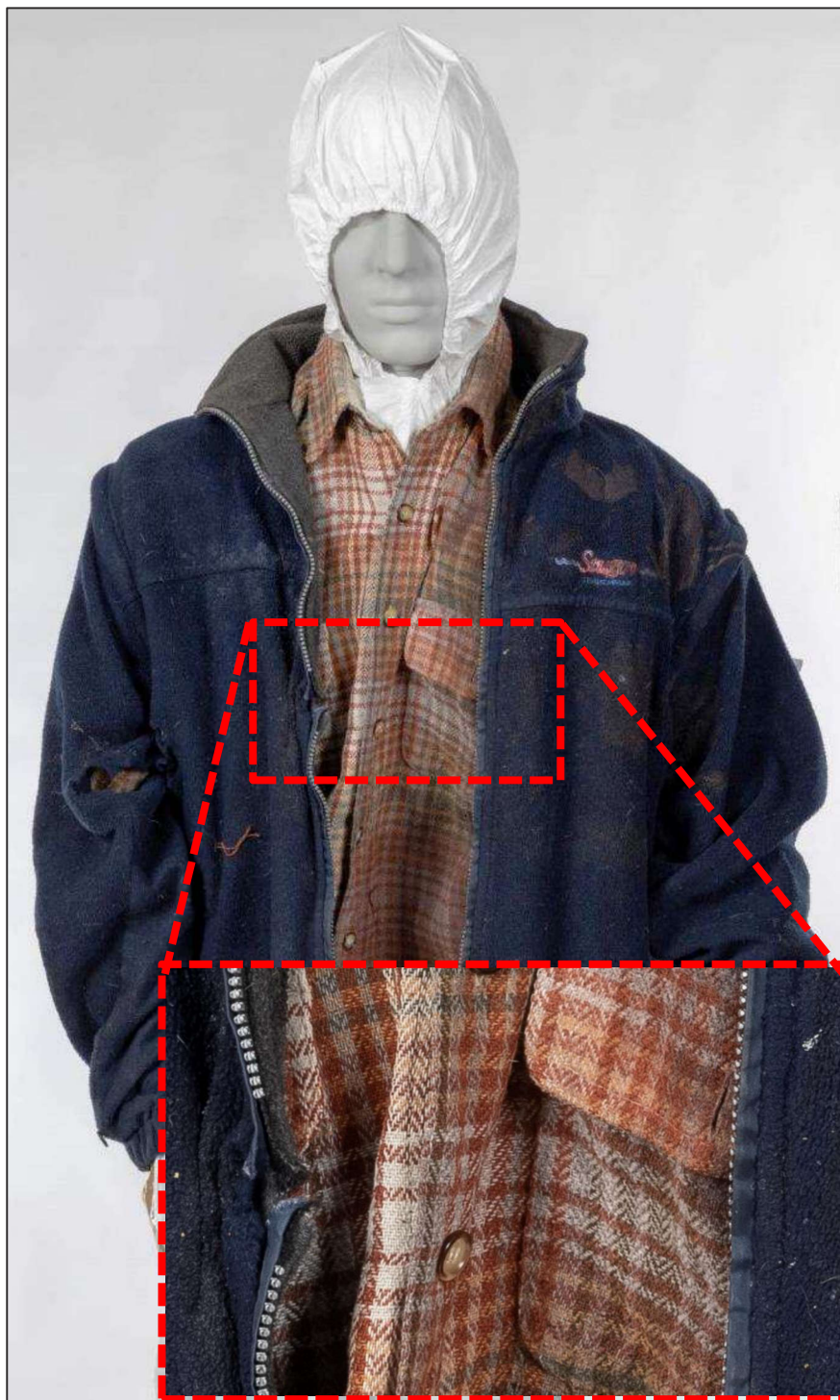
Bild 3 Inklippt bild visar skadan i dragkedjan. På motsatta sidan är dragkedjan oskadd. Observera hur skadan är utormad som en skål, vilket innebär att skaderiktningen är från vänster till höger.
