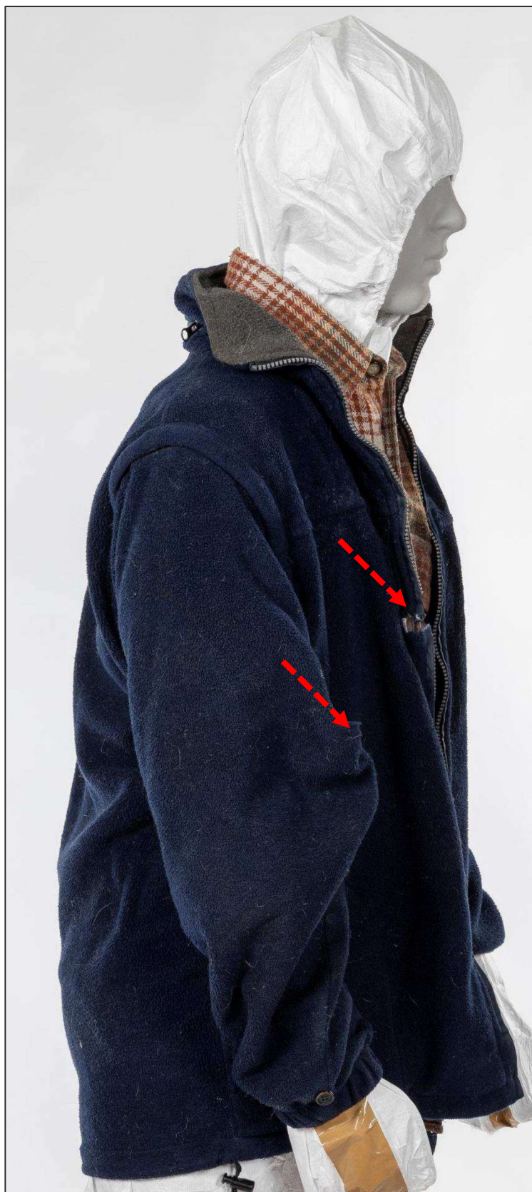
Bild 6 Översiktsbild fleecetröjans högra sida. Markeringar visar skador på tröjan.
