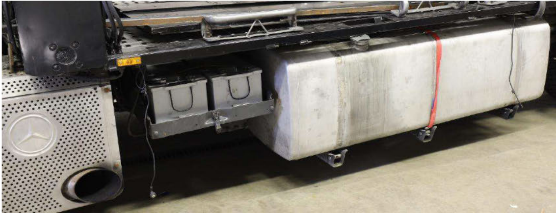
Bild 12. Avgasröret, batterierna och tanken på den vänstra sidan på dragbilen i beslag M-20-1272 p.1, var vid undersökningstillfället blottade från de två täckplåtarna som normalt skyddar denna sida.
