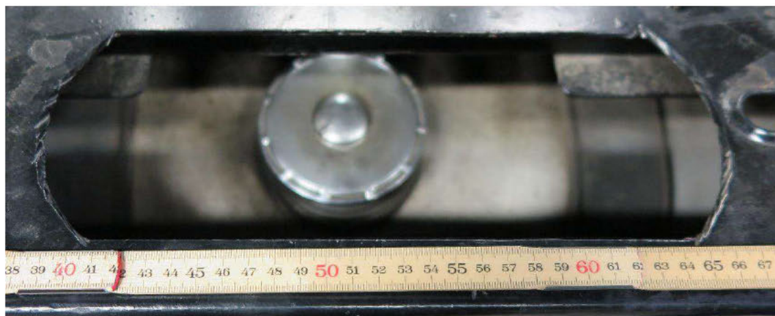
Bild 23. På höger sida på dragbilen i beslag M-20-1272 p.1, ovanför den andra tanken, ser det ut som det sågats i balken ovanför tankrörets mynning.
