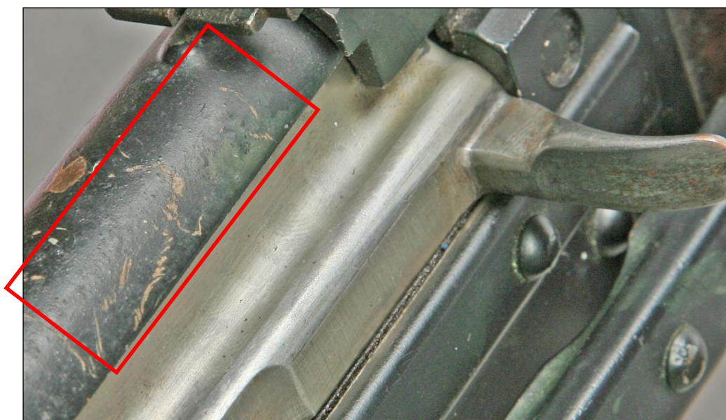
Bild 5. Bild på främre delen av skyddskåpan på vapnet 2021-5000-BG111068-1. På bilden syns samma karaktäristiska slitage som på vapnet i filmfilen.
