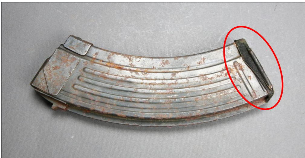
Bild 7. Bild på magasinet till vapnet 2021-5000-BG111068-1. På bilden syns hur magasinets nedersta del är lindat med någon form av vävtejp (markerat med röd ring).
