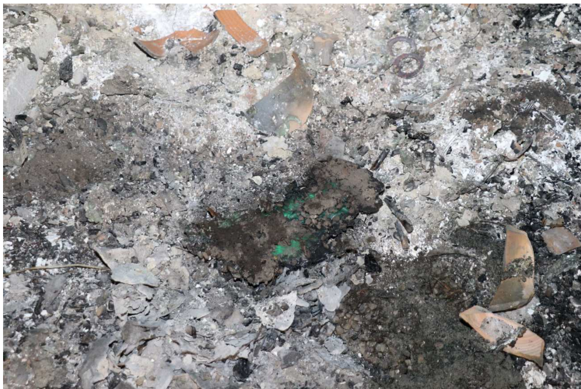
Figur 18. Grön plastsmälta som anträffades i anslutning till gräsklipparen och där det påvisades motorbensin.
